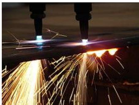
Figura 120: Ilustración visual proceso de oxicorte.
