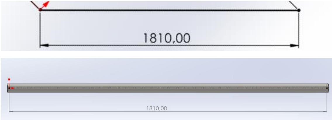
Figura 83: Croquis 2D y Modelo 3D donde se muestra la longitud final del eje guía.
