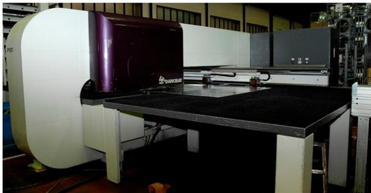
Figura 119: Cizalladora controlado por CNC. Instantánea ofrecida por SOME StampingSolutions.
