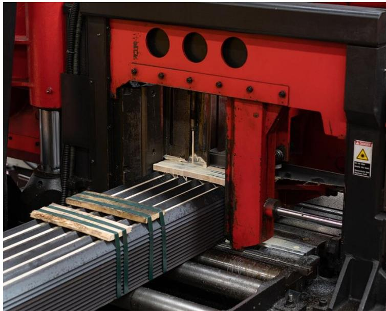
Figura 114: Captura ofrecida por Planes referente al proceso de corte de perfiles comerciales mediante sierra de cinta.
