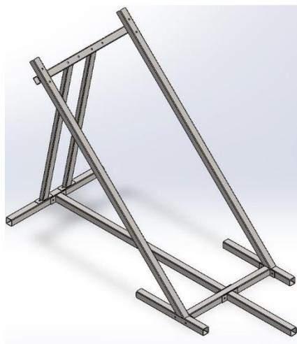
Figura 20: Perfiles comerciales que componen el sistema estructural.
