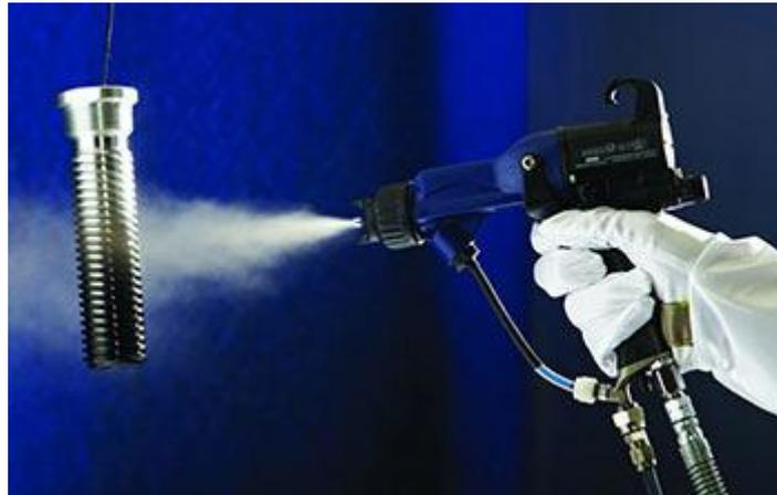
Figura 132: Pulverizado electrostático en acción.
