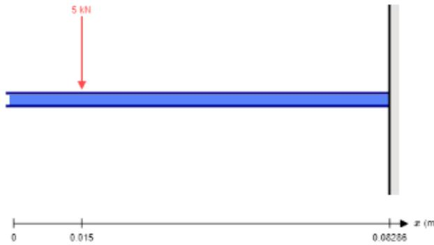
Figura 4: Dibujo chapa con situación de la carga y apoyo empotrado.
