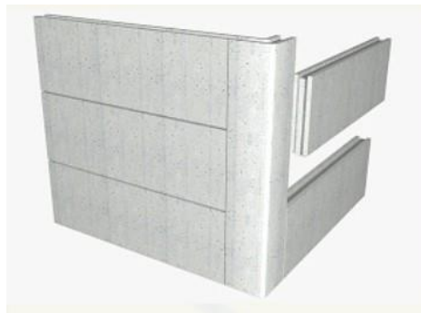
Ilustración 9. Hormigón pretensado de las fachadas
