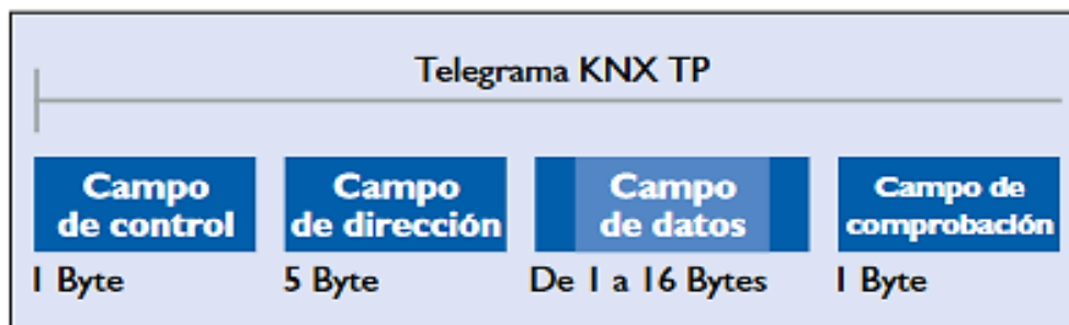
Figura 3. Estructura de trama KNX TP
