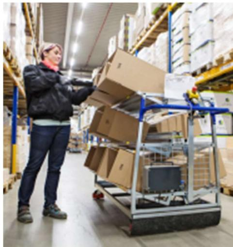
**Ilustración 13. Carro recogepedidos (Cardós Carboneras, 2020c)**
