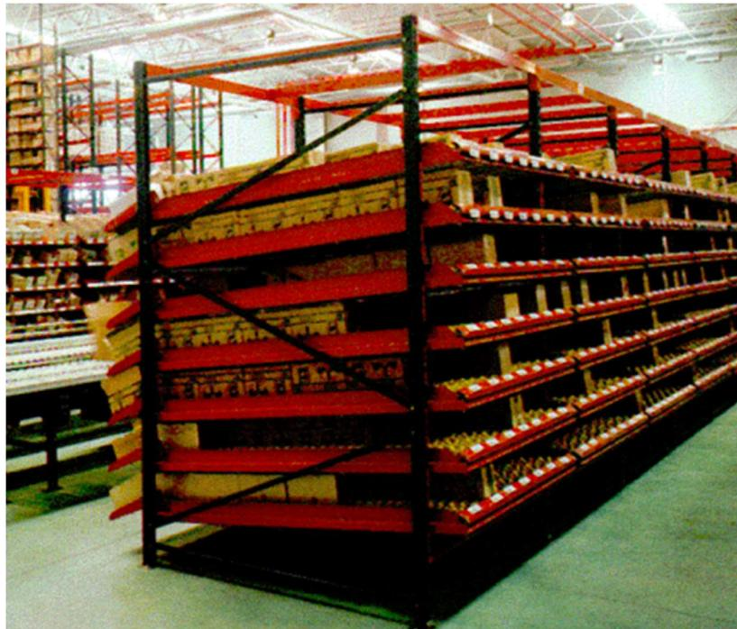
**Ilustración 5. Estanterías dinámicas (Cardós Carboneras, 2020b)**
