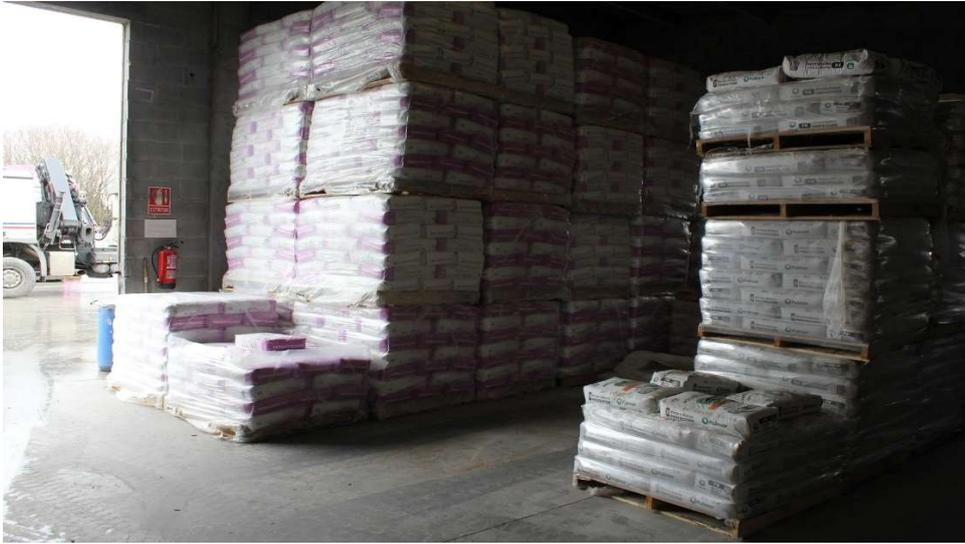
**Ilustración 2. Almacenamiento en bloque (bloques apilados, 2021)**
