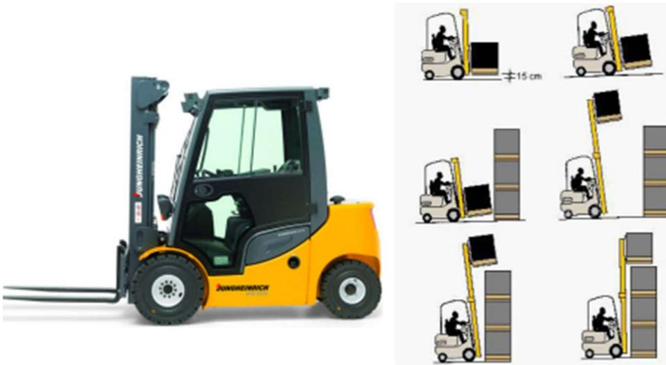
**Ilustración 10. Carretilla contrapesada (Cardós Carboneras, 2020c)**
