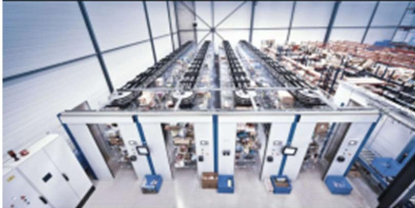
**Ilustración 8. Carrusel horizontal (Cardós Carboneras, 2020b)**
