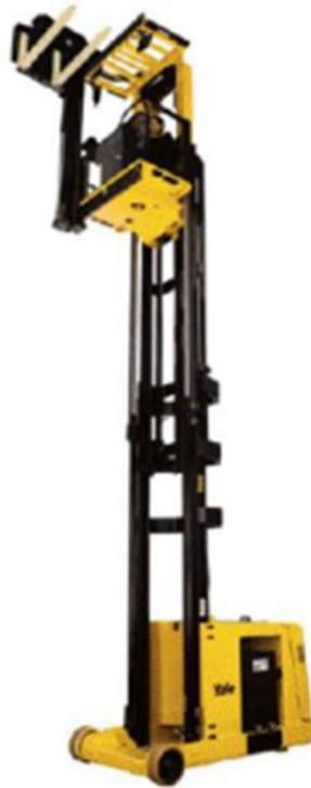
**Ilustración 12. Carretilla trilateral combi (Cardós Carboneras, 2020c)**
