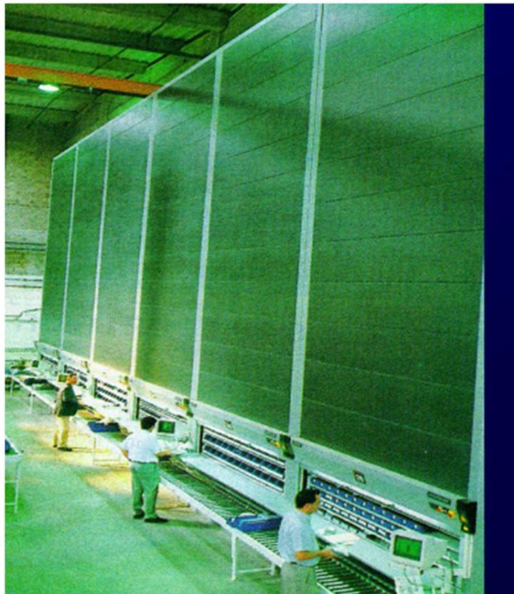
**Ilustración 7. Almacén rotativo vertical Paternoster (Cardós Carboneras, 2020b)**
