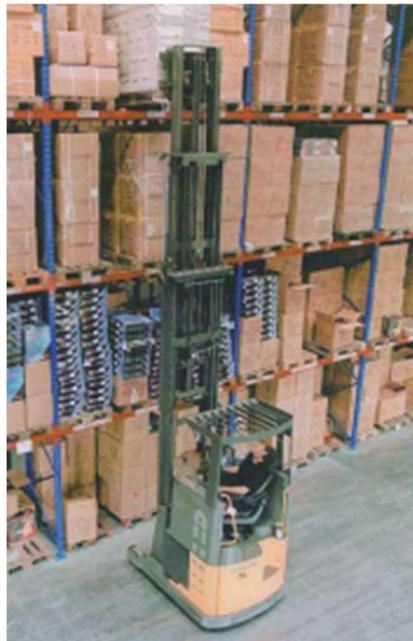
**Ilustración 11. Carretilla retráctil (Cardós Carboneras, 2020c)**
