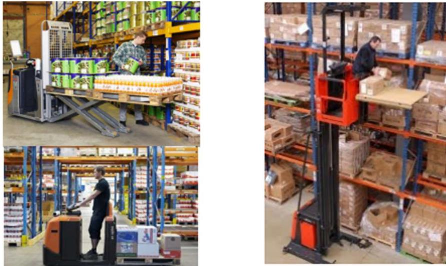
**Ilustración 14. Carretillas recogepedidos (Cardós Carboneras, 2020c)**
