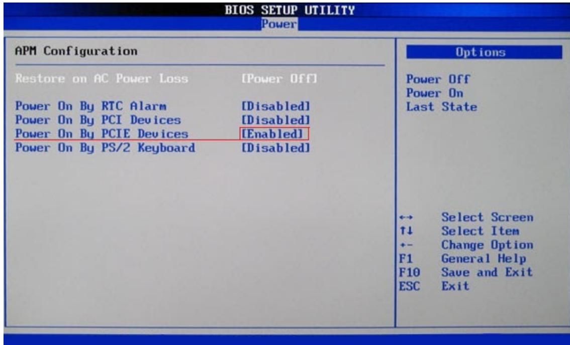
Figura 6.10: Interfaz de «BIOS» en la que se ve la opción para despertar el servidor mediante dispositivos conectados a la interfaz PCIe
