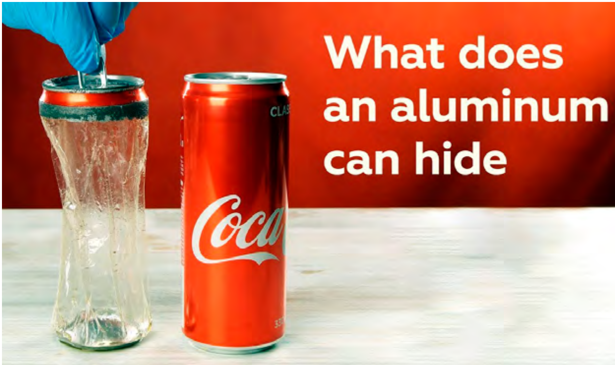
Imagen 9. Experimento sobre el plástico en las latas de aluminio.
