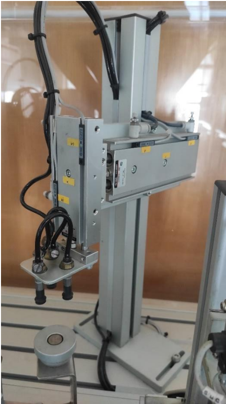
Figura 44. Etapa "Colocación de tapa" (real).
