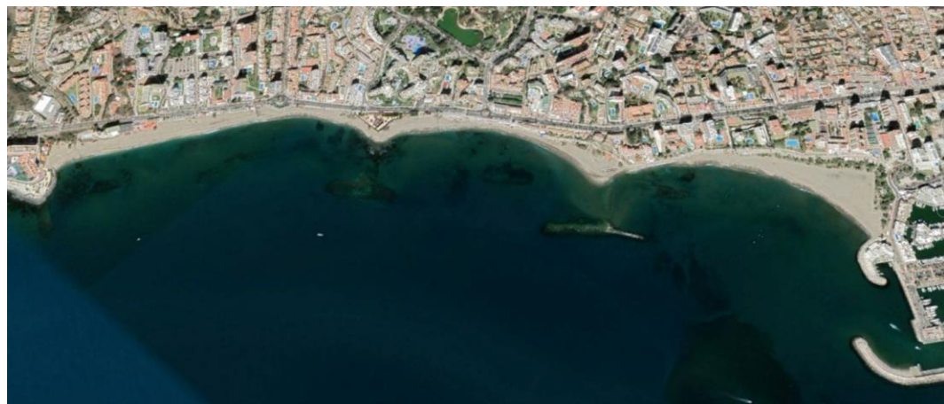
Fig. 26 Comparación de la playa de Benalmádena entre los años 2005 y 2022, donde se puede observar como con diques exentos se ha conseguido mantener la playa estable en su conjunto sin interrumpir totalmente el transporte sólido-litoral. Fuente: Google Earth.
