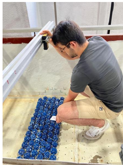
Fig. 53 Medición del coeficiente de capa de la primera capa según el método de Keyser y Jacobs (2020). Fuente: elaboración propia.
