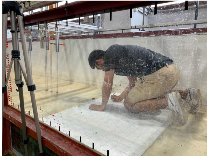
Fig. 51 Colocación de la plantilla de la malla y dibujado de los puntos. Fuente: elaboración propia.
