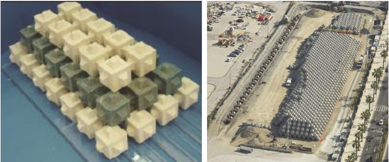
Fig. 107 Acopio de Cubípodo en el laboratorio (izquierda) y en el puerto de Malaga (derecha). Fuente: web del Cubípodo.
