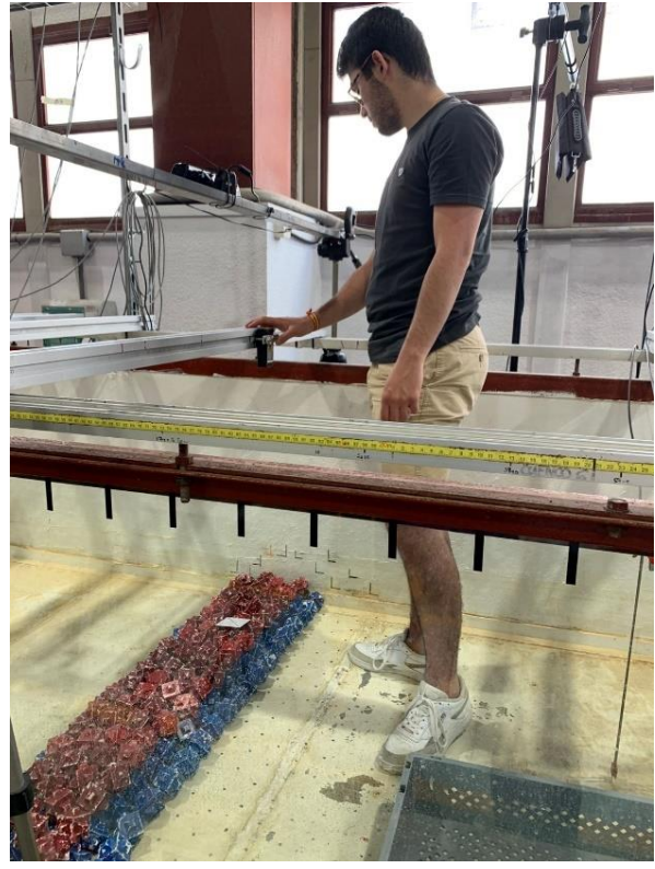
Fig. 54 Construcción y medición del coeficiente de capa de la segunda capa. Fuente: elaboración propia.
