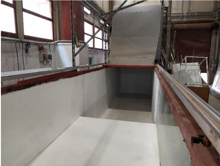
Fig. 38 Final del canal y talud (donde se observan los ladrillos huecos y los cubos de mortero. Fuente: elaboración propia.
