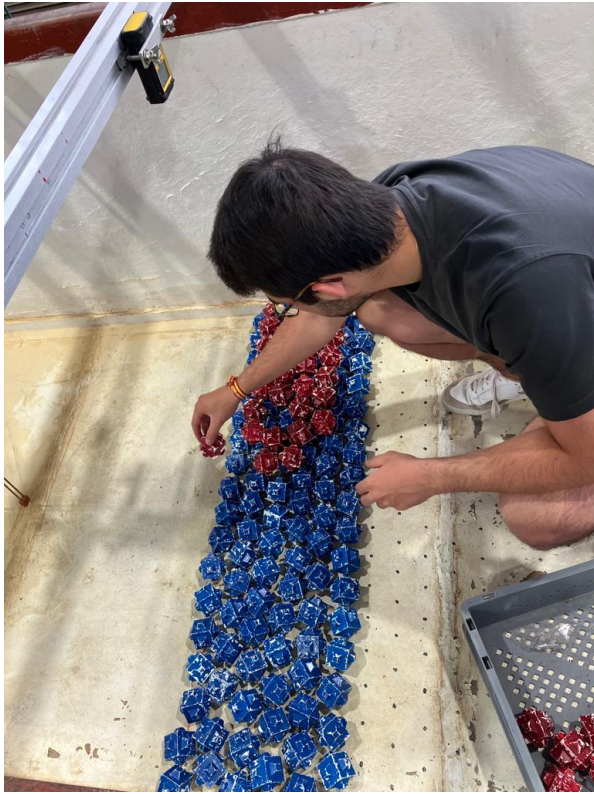
Fig. 54 Construcción y medición del coeficiente de capa de la segunda capa. Fuente: elaboración propia.
