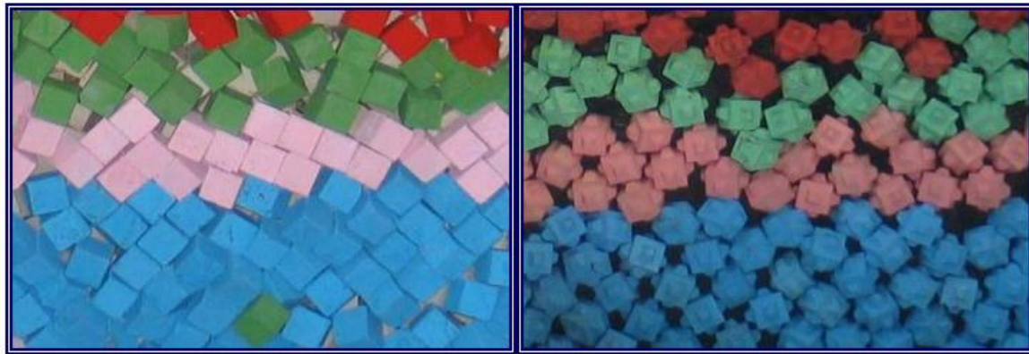
Fig. 16 Adoquinamiento natural de los cubos frente a la aleatoriedad de los Cubípodos. Fuente: Corredor y Medina, 2011.
