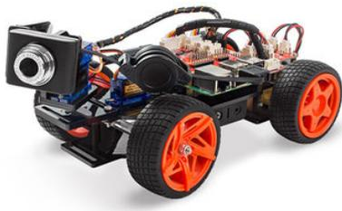
Es el coche que recorrerá el circuito y reconocerá señales utilizando el modelo entrenado. El coche **PiCar** es un robot de código abierto basado en **Raspberry Pi**.
