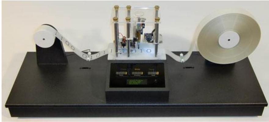
Figura 1: Representación física de la idea de una máquina de Turing, con cinta finita, en la idea sería infinita.
