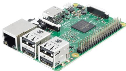
Una placa **Raspberry Pi** que irá montada sobre el coche **PiCar** y tendrá conectada la cámara y el acelerador USB de **Coral AI**. La placa funcionará con un sistema operativo Linux y controlará los diferentes componentes y ejecutará los *scripts* necesarios.
