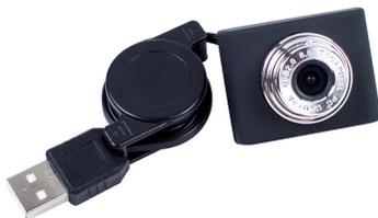
Una cámara incluida con el coche **PiCar** que se utilizará para capturar imágenes de la dirección del coche y que serán enviadas a la **Raspberry Pi** para su procesamiento.
