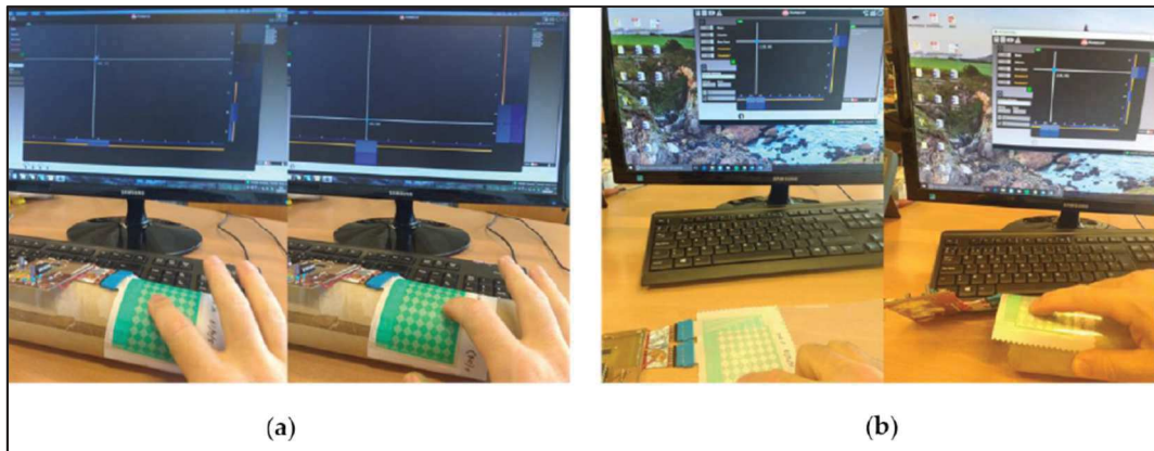
Figura 42.- “Patterning”: Ferri et al, presentan un “touchpad” textil basado en una geometría de diamante mediante serigrafía. En la figura (a) prueba de funcionamiento en una superficie curva que toca dos puntos diferentes; y (b) prueba de funcionamiento tocando en el mismo punto, pero sobre una superficie plana y curva, obteniendo el mismo resultado. Fuente:[100].
