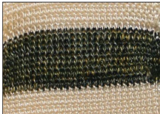
Figura 39.- “Kintting”: Maziz et al, presentan músculos artificiales con fibras electroactivas como una estructura de género de punto para monitorización respiratoria que comprende hilos recubiertos de polímero conductor (hilo negro) tejido junto con hilo normal (blanco). Fuente:[82].
