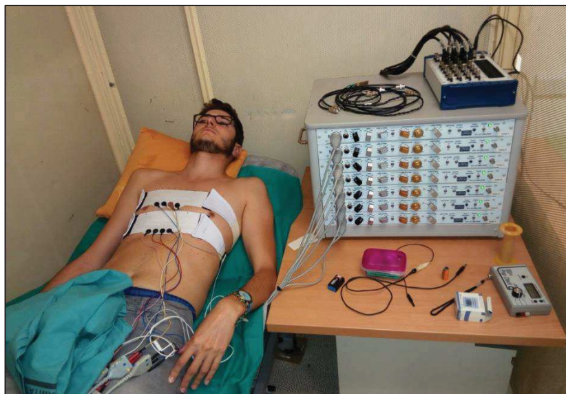
Figura 33. Fotografía de la colocación de los BCE's en el tórax con los cables colocados en los conectores que a su vez están conectados a un RACK con amplificadores P511. La salida está conectada a la tarjeta convertidora ADC 6229 de N.I. el sujeto está dentro de una jaula de Faraday. Fuente: propia.
