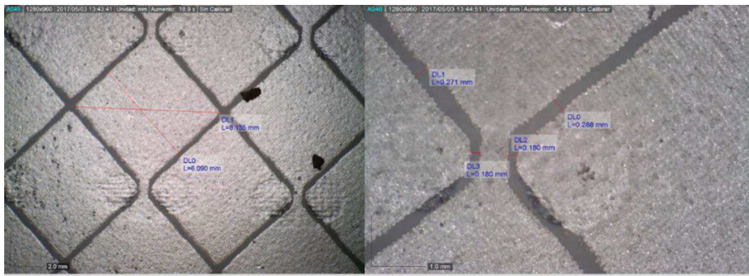
Figura 72. Detalles dimensionales del sensor D3.2-1. Fuente: propia.
