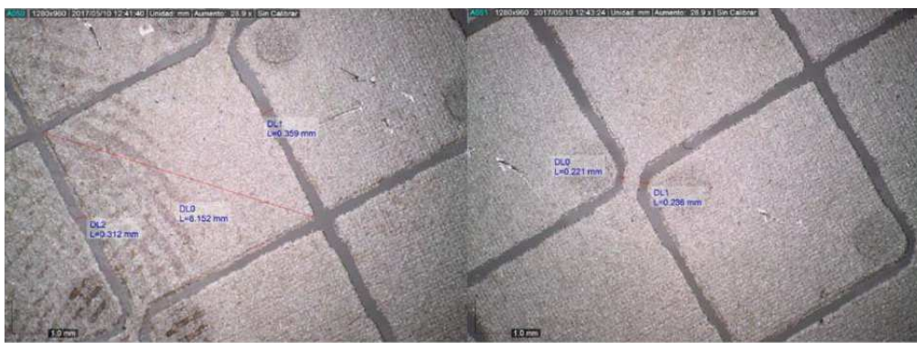
Figura 67. Detalles dimensionales del sensor D3.1. Fuente: propia.
