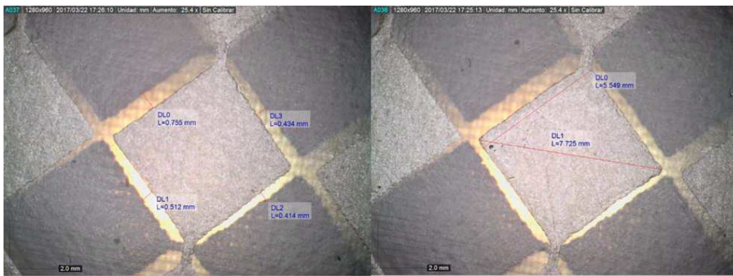
Figura 40. Detalles dimensionales del sensor D0.1. Fuente: propia.
