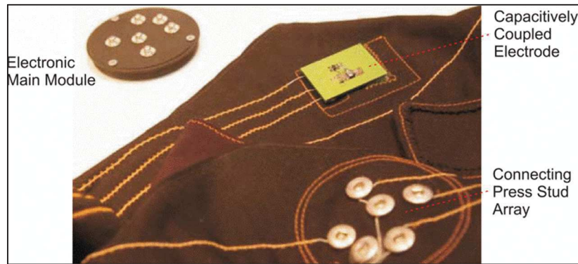
Figura 53.- Componentes del sistema de monitorización integrado textil por electrodo acoplado capacitivamente. Fuente: [164].
