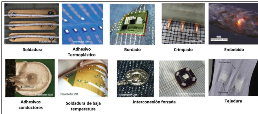
Figura 46.- Métodos de incorporación de textiles externos al textil. Fuente: propia.
