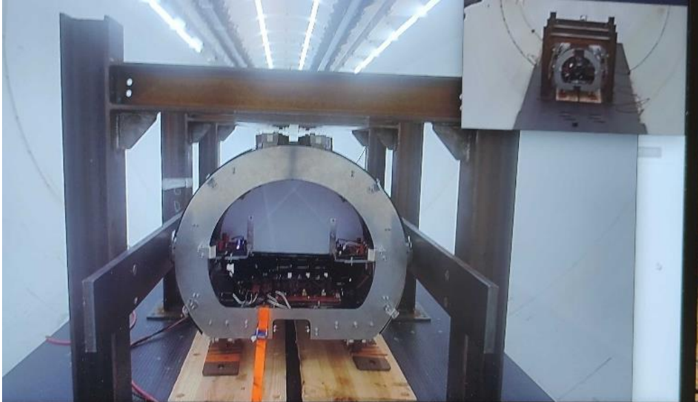
Figura 212. Auran levitando durante el ensayo de vacío
