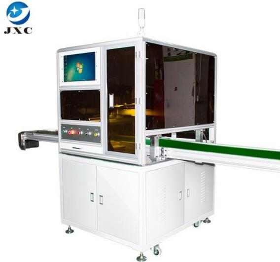
*Figura 4. Máquina De Inspección Visual Ccd De Alta Precisión*
