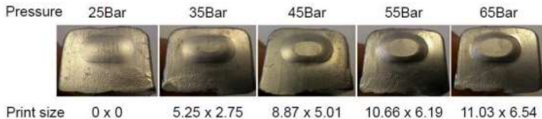
Figura 22. Diferencia de huella en la unión debido al aumento de presión del grupo hidráulico (Fuente: Material de la empresa).
