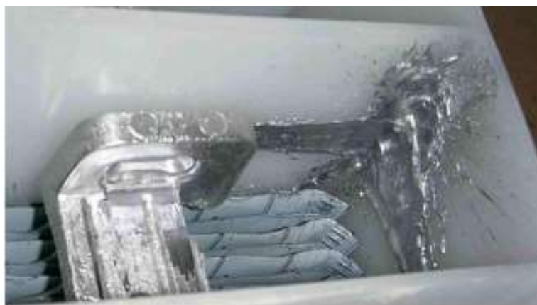
Figura 23. Proyección producida por exceso de energía aportada en la soldadura (Fuente: Material de la empresa).
