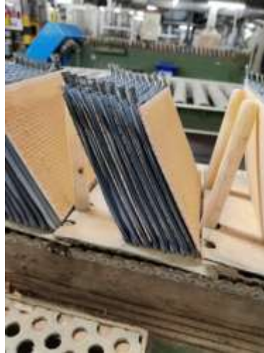
Figura 28. Paquete de placas antes de entrar en la etapa de COS (Fuente: Elaboración propia).
