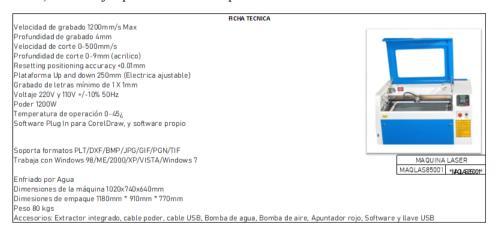
Fig. 1.2 Ficha técnica de la maquina laser.
