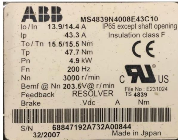
Figura 10. Placa de características del ABB MS4839.
