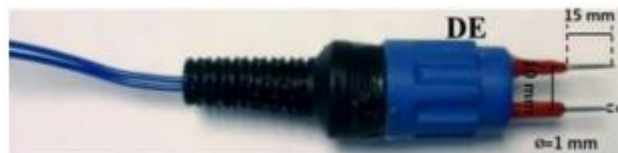
Figura 8: Sensor de doble aguja de acero inoxidable
