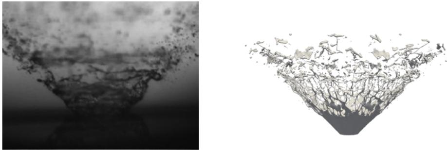
Figura 4.7: Comparación de la atomización primaria obtenida experimentalmente con la obtenida en la simulación del sector de  $25^\circ$  rotado para completar los  $360^\circ$  [1].
