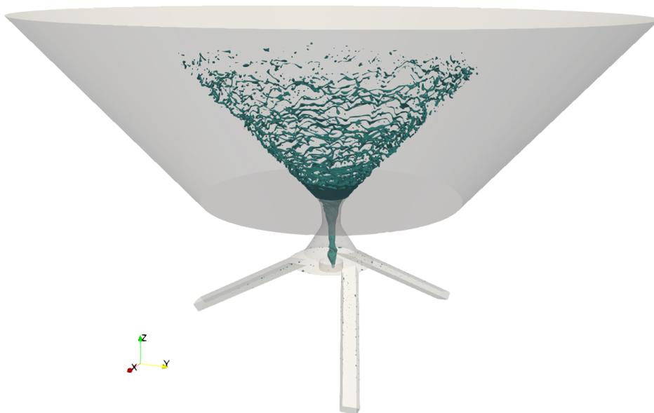
Figura 5.2: Contorno instantáneo de la isuperficie de la fracción volumétrica de líquido  $\alpha_{fuel} = 0.5$  con vista de la geometría para el caso de estudio.
