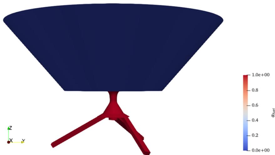
Figura 4.22: Condiciones iniciales para la fracción de líquido  $\alpha_{fuel}$ .
