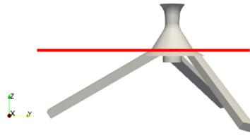
Figura 5.15: Plano considerado para el estudio del espesor del núcleo de aire situado en  $Z = -550 \mu m$ .
