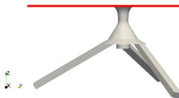
Figura 5.10: Plano considerado para el estudio del espesor de la película de combustible situado en  $Z = 0 \mu m$ .
