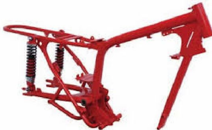
Figura 14: Chasis tubular de cuna abierta.
