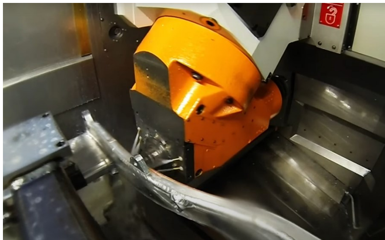
Figura 174: Ejemplo de taladrado en un chasis Kalex.
