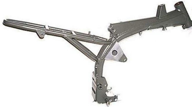
Figura 18: Chasis tubular de espina central.
