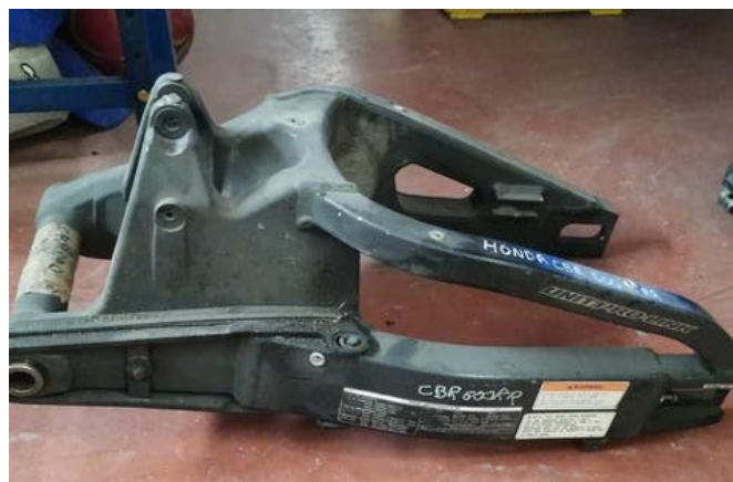
Figura 47: Basculante honda CBR 600rr.
