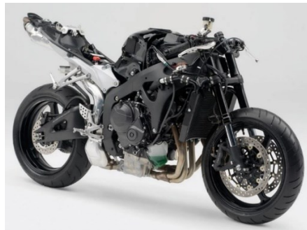
Figura 29: Honda cbr 600 rr sin carenado.
