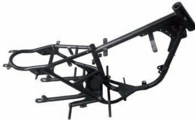
Figura 13: Chasis tubular de cuna cerrada.
