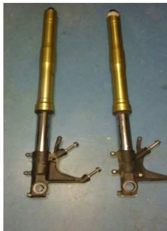
Figura 41: Horquillas honda CBR 600rr.
