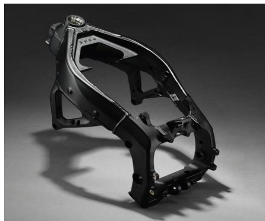
Figura 32: Chasis de una Yamaha r6 2021.
