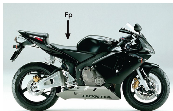
Figura 89: Aplicación de carga de la prensa vertical.
