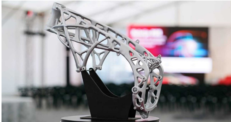
Figura 24: Chasis impreso en 3D.
