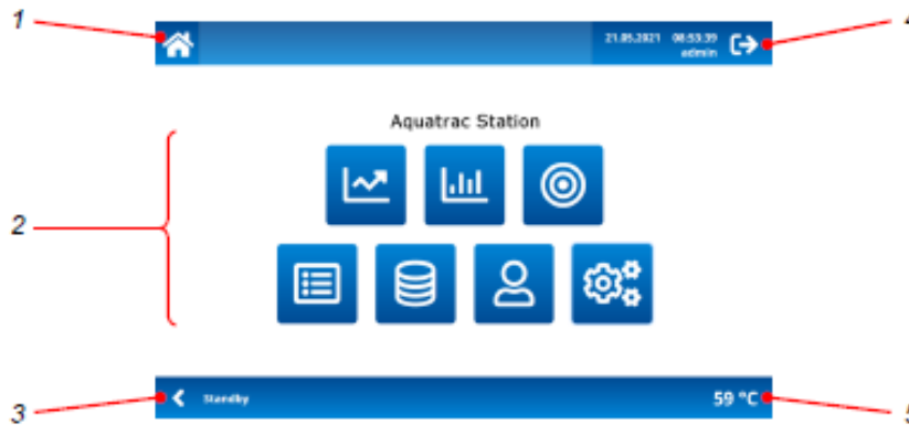
Figura 3: Cuadro de mandos del equipo 1. Botón de inicio; 2. Botones de menú; 3. Botón "VOLVER"; 4. Botón "CERRAR SESIÓN"; 5. Visualización de temperatura en el equipo de medición (>60°C ¡PELIGRO DE QUEMADURA!)
