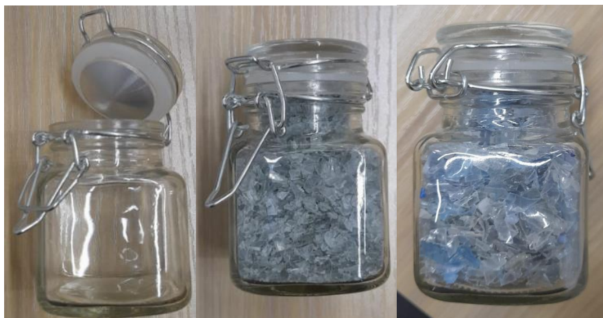
Figura 20: Recipiente para almacenar PET previo al ensayo de humedad. De izquierda a derecha: vacío; con reciclado interno de PET, con reciclado externo procedente de botellas de PET
