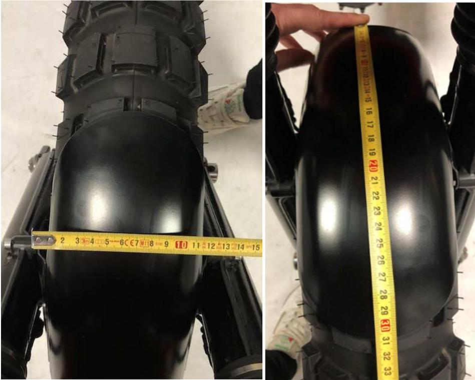
*Ilustración 66. Ejemplo imagen longitud y ancho del guardabarros trasero*
