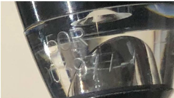
*Ilustración 67. Ejemplo 1 imagen contraseña homologación intermitente trasero*
