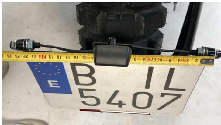
*Ilustración 70. Ejemplo imagen distancia entre intermitentes traseros*
