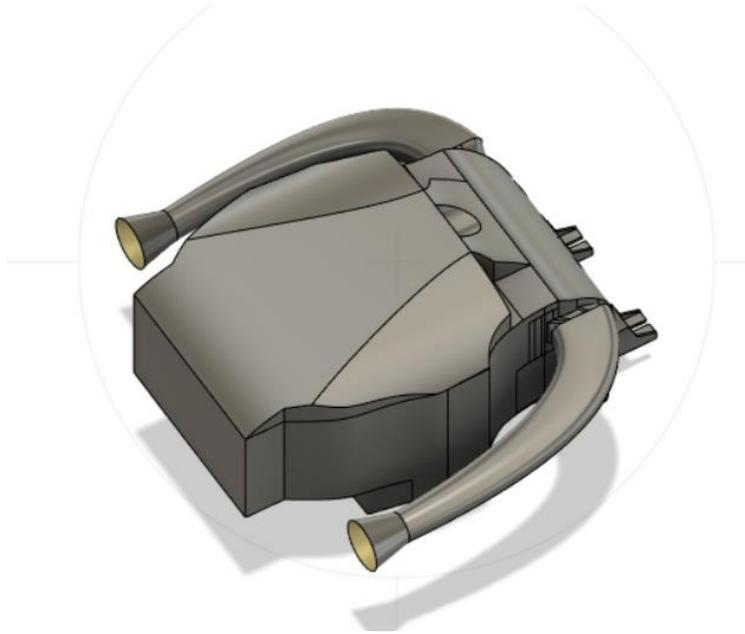
*Ilustración 58. Ejemplo 1 imagen caja de admisión de aire*
