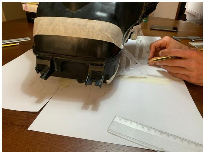
*Ilustración 85. Toma de medidas 3 del sistema de admisión de aire.*
