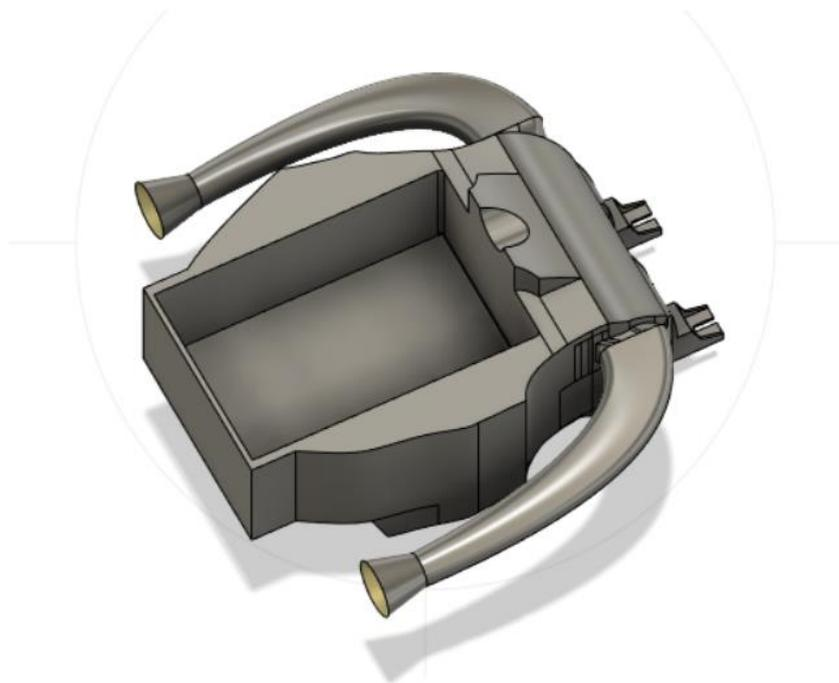
*Ilustración 59. Ejemplo 2 imagen caja de admisión de aire*
