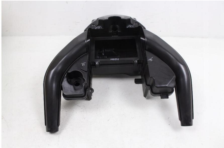
*Ilustración 7. Vista frontal de la caja de admisión de aire*
