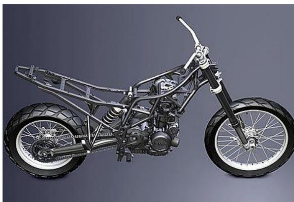
*Ilustración 18. Estructura conjunto chasis BMW F 800 GS*
