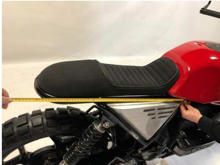
*Ilustración 64. Ejemplo 1 imagen longitud subchasis*
