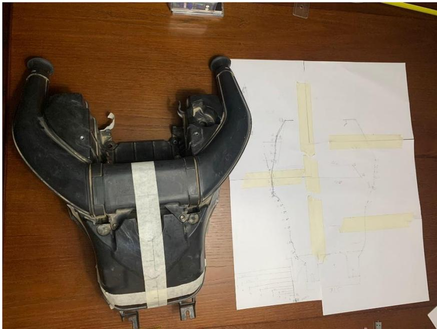
*Ilustración 83. Toma de medidas 1 del sistema de admisión de aire*
