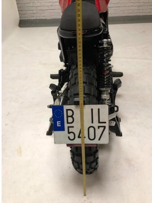
*Ilustración 73. Ejemplo imagen altura piloto trasero y luz de matrícula*
