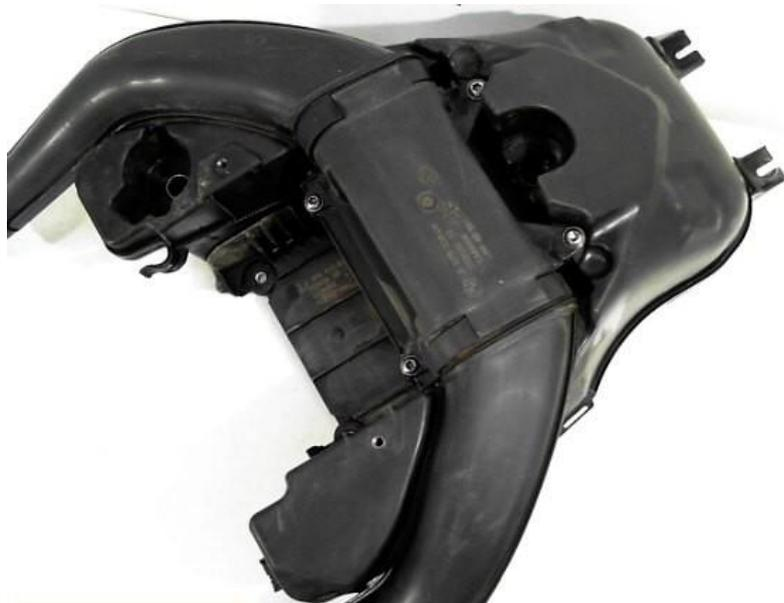
*Ilustración 8. Vista lateral de la caja de admisión de aire*
