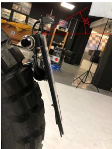
*Ilustración 57. Ejemplo 2 imagen inclinación matrícula*
