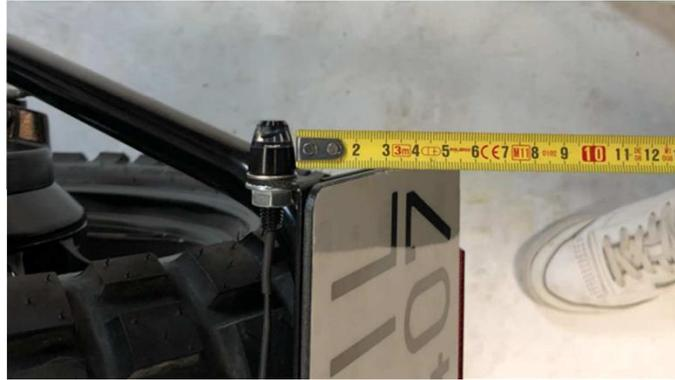
*Ilustración 71. Ejemplo imagen voladizo desde zona lumínica hasta el final del vehículo*
