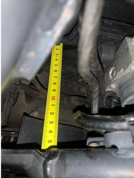
*Ilustración 90. Toma de medidas de la nueva ubicación de las baterías*
