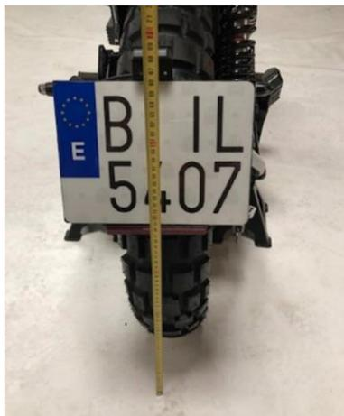
*Ilustración 55. Ejemplo 1 imagen altura matrícula*
