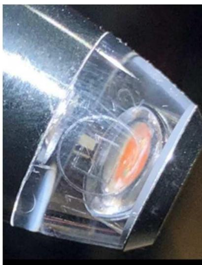
*Ilustración 68. Ejemplo 2 imagen contraseña de homologación intermitente trasero*
