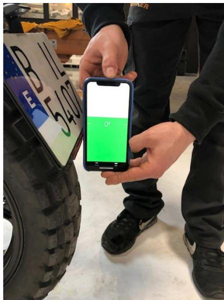
*Ilustración 76. Ejemplo imagen inclinación del catadióptrico*
