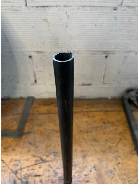
*Ilustración 86. Tubo de Acero cromo-molibdeno de 25 mm x 2 mm*
