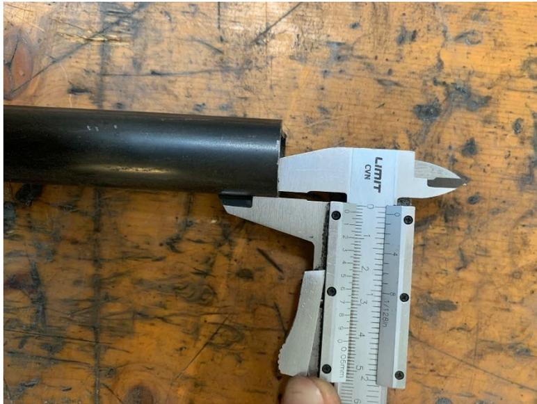
*Ilustración 88. Espesor del tubo del subchasis*
