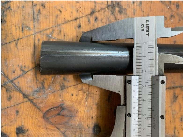
*Ilustración 87. Diámetro del tubo del subchasis*
