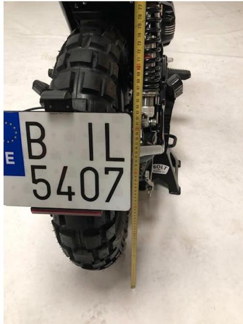
*Ilustración 69. Ejemplo imagen altura intermitentes traseros*
