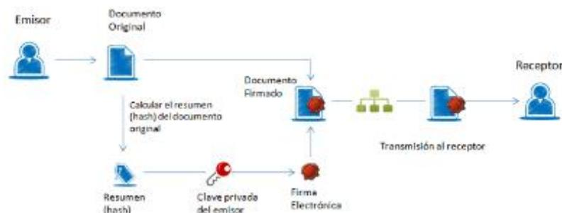
*Ilustración 1. Proceso de firma electrónica simple.*
