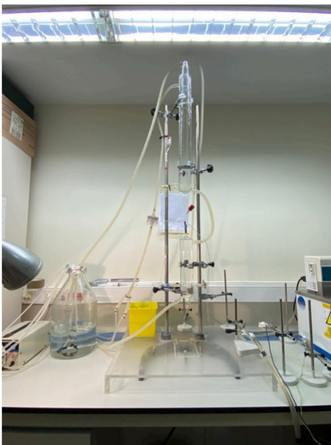
Figura 2.9: En la parte derecha se encuentra el sistema de perfusion Langgendorff del laboratorio de electrofisiología de la UV. En la parte izquierda se encuentra el corazón de rata conectado al sistema con la cánula diseñada, el catéter y un estimulador.
