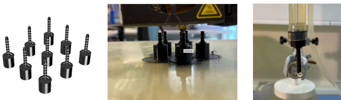
Figura 2.8: Proceso de ensamblaje mediante adhesivo termoplástico para ofrecer resistencia mecánica a las acciones de conexión/desconexión repetitivas.
