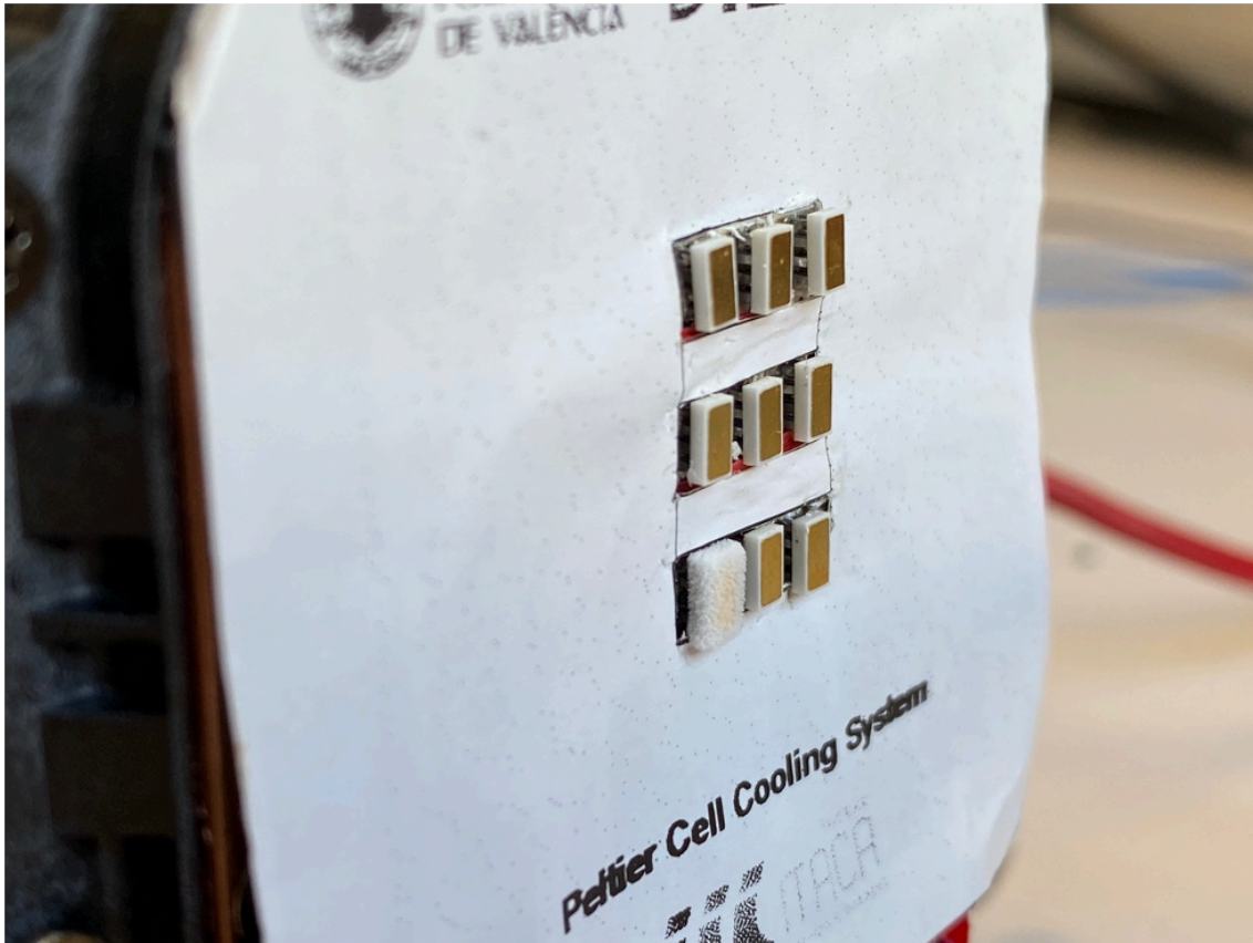
Figura 3.15: Sistema de refrigeración con una de las células de Peltier encendidas congelando la condensación ambiente.
