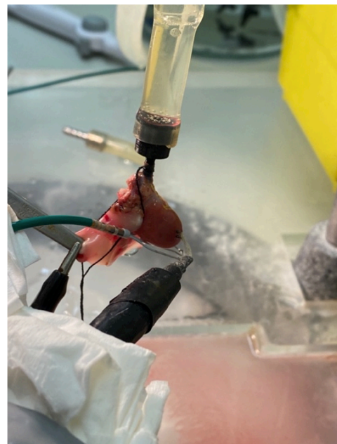
Figura 2.9: En la parte derecha se encuentra el sistema de perfusion Langgendorff del laboratorio de electrofisiología de la UV. En la parte izquierda se encuentra el corazón de rata conectado al sistema con la cánula diseñada, el catéter y un estimulador.
