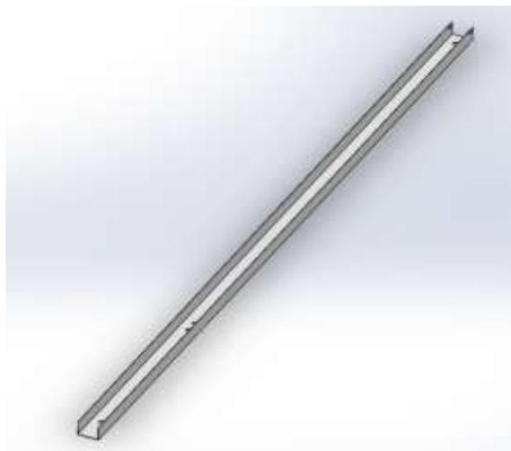
*Figura 16: perfil diseñado para asegurar la estructura al tejado y fijar la parte inferior del actuador lineal al mismo.*
