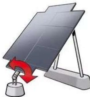
Figura 9: seguidor solar de un eje polar
