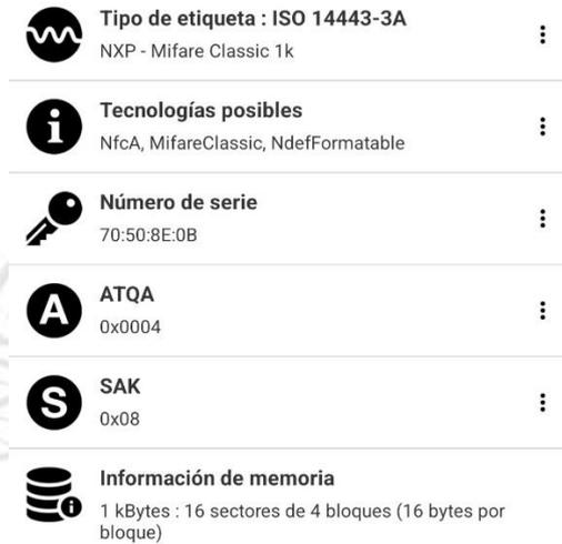
**Figura 32. Características duplicado tarjeta NFC de cerradura electrónica**
