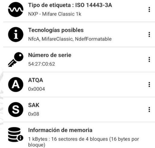
Figura 30. Características tarjeta original de cerradura electrónica
