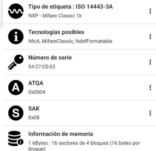
Figura 31. Características duplicado llavero RFID de cerradura electrónica
