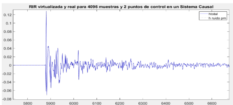
Fig 32. RIRs para 4096 muestras y 2 micrófonos de monitorización en un sistema causal
