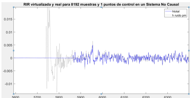
Fig 40. RIRs para 8192 muestras y 1 micrófono de monitorización en un sistema no causal
