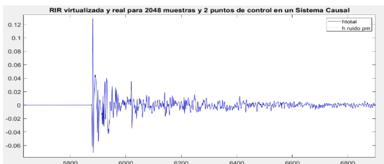
Fig 31. RIRs para 2048 muestras y 2 micrófonos de monitorización en un sistema causal
