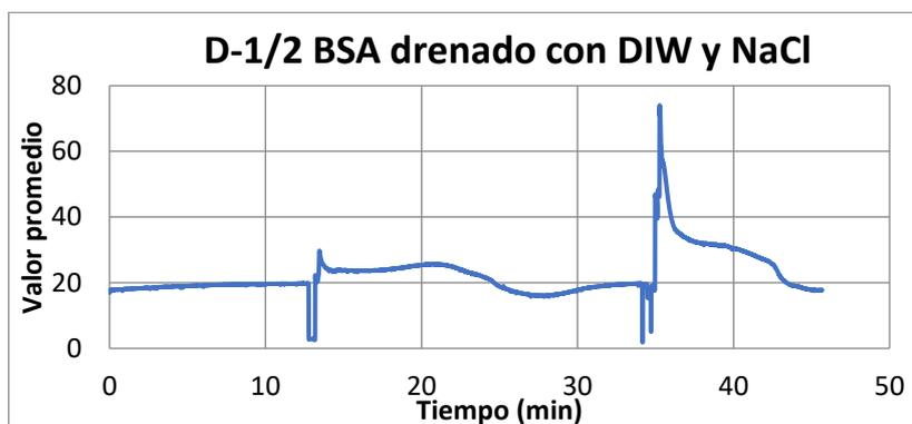
Figura 38: Prueba de D-1/2 BSA aplicando DIW y distintas concentraciones de NaCl
