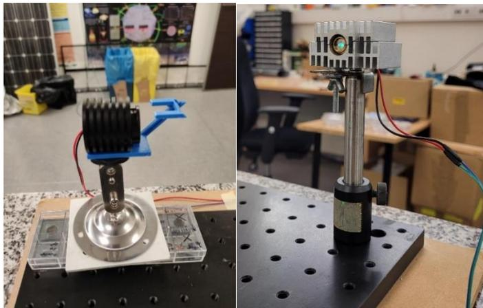
*Figura 16: Fuente de luz láser roja (izq) y verde (der)*
