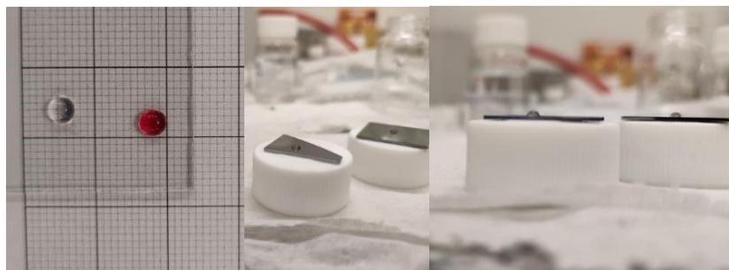
*Figura 18: Dos gotas de DIW de 4 mm de diámetro (color rojo y transparente) y dos gotas de PMMA depositadas sobre obleas de silicio*
