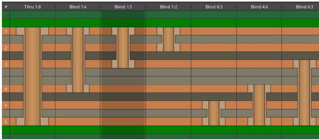
Figura 3.11: Detalle de las vías utilizadas.
