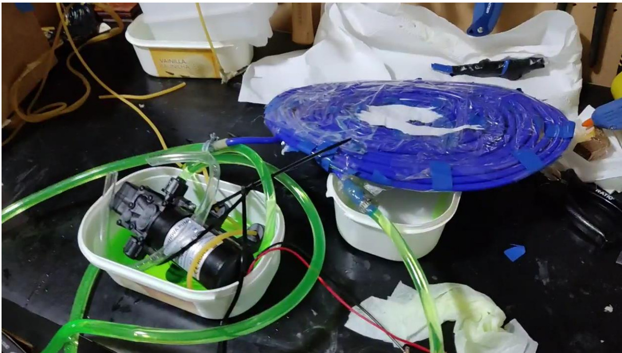
Ilustración 54. Prueba de concepto sistema de mecánica fluidos con casco de refrigeración.
