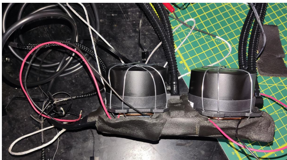
Ilustración 47. Montaje 2 células peltier 100W en bloque de enfriamiento etapa final.
