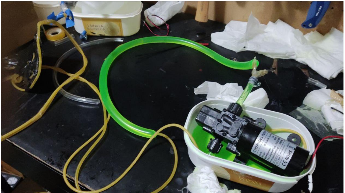
Ilustración 53. Montaje sistema de mecánica de fluidos con bomba de agua de alta presión.
