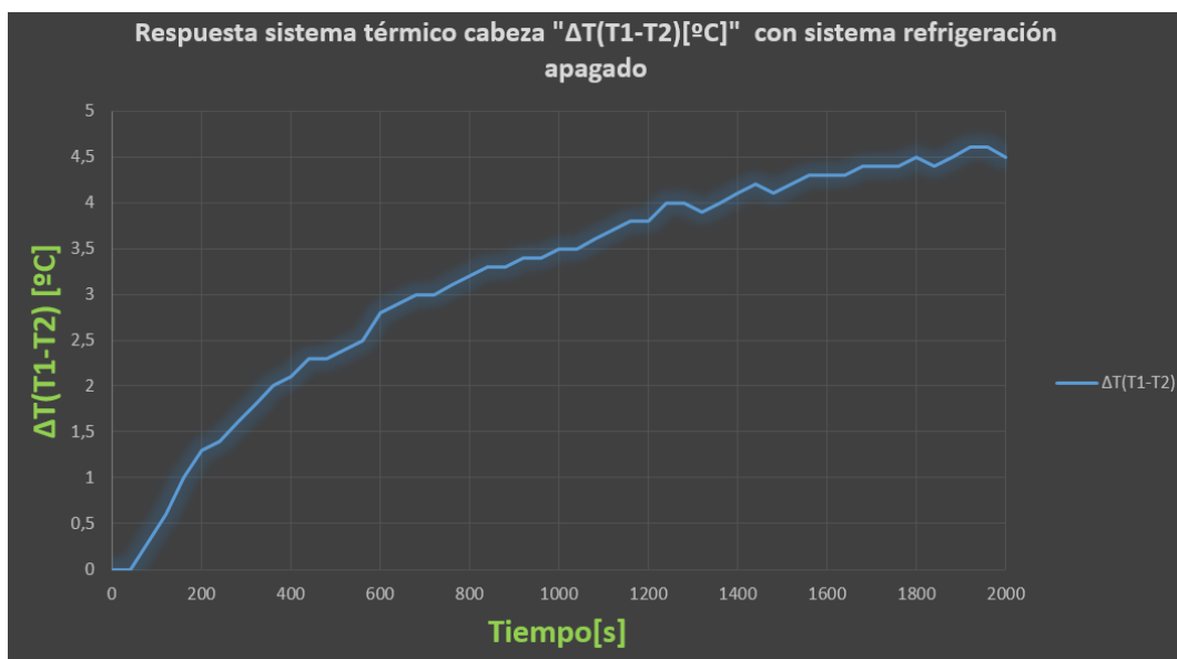
Ilustración 69. Respuesta temporal en casco de refrigeración ΔT con paciente y con el sistema de refrigeración apagado.
