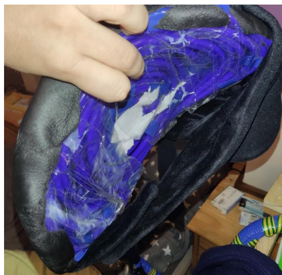
Ilustración 58. Vista en detalle casco de refrigeración.
