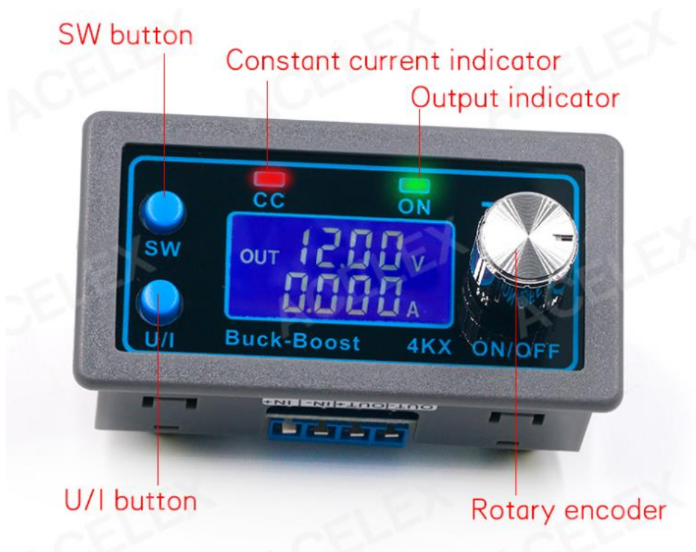
Ilustración 39. Convertidor buck/boost ZK4KX 35[W], control sistema de refrigeración líquida.
