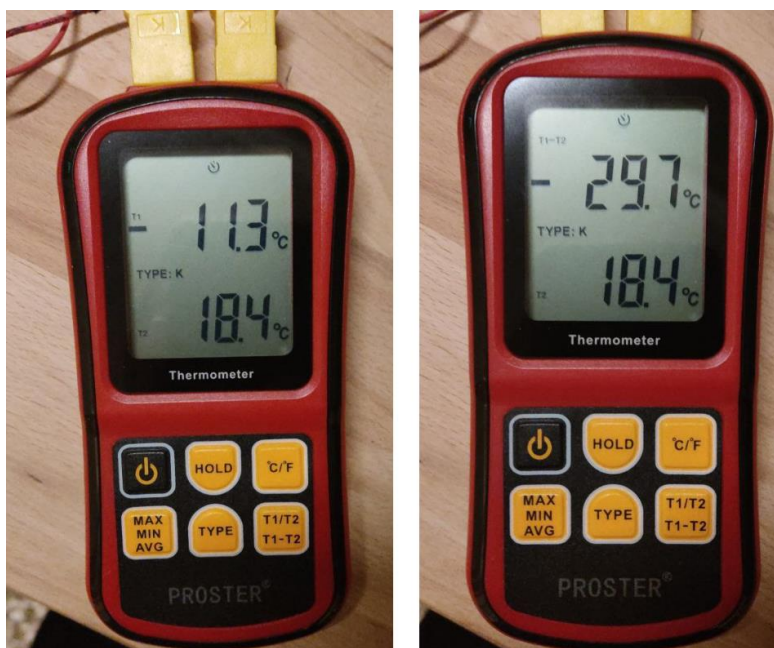
Ilustración 51. (1) Medida de temperatura en bloque de enfriamiento "T1" y Ambiente "T2", (2) Diferencia de temperatura entre bloque de enfriamiento y ambiente "T1-T2".
