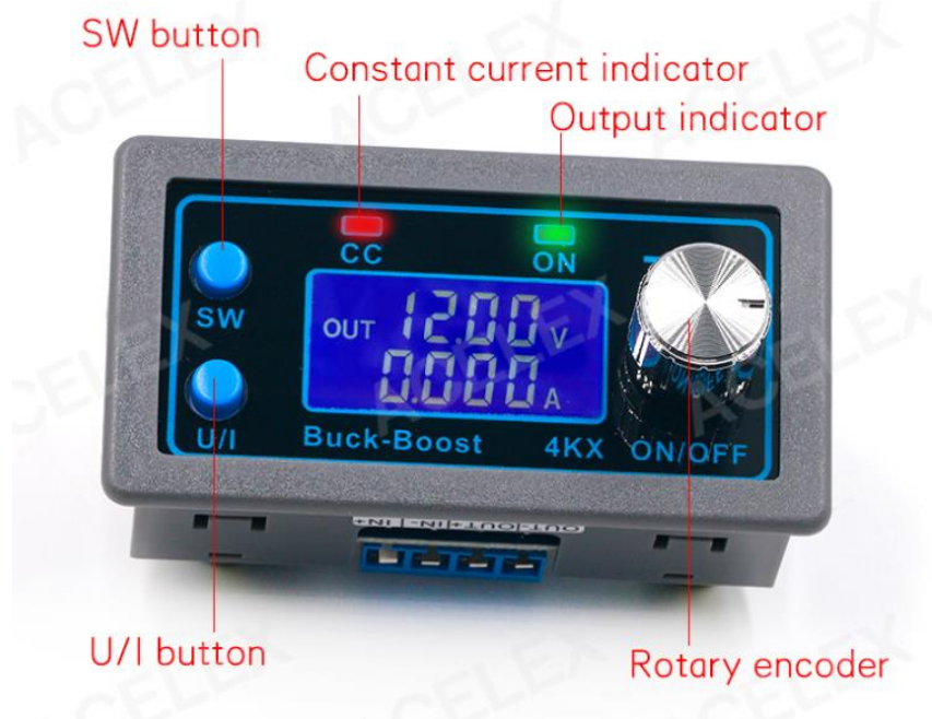
Ilustración 45. Convertidor buck/boost ZK4KX 35 [W], es seleccionado para el control del sistema de refrigeración líquida "PS2" y otro convertidor igual para el control de la bomba del sistema de mecánica de fluidos "PS3" del prototipo 0 .
