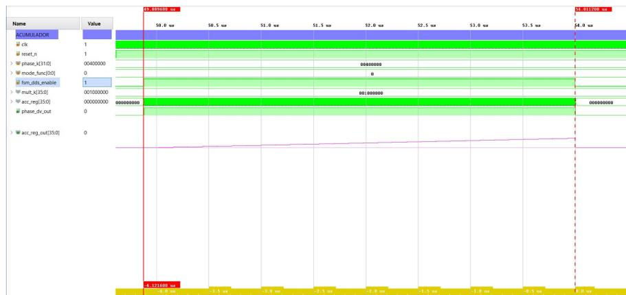
**Figura 64: Simulación del acumulador en modo pulso único**
