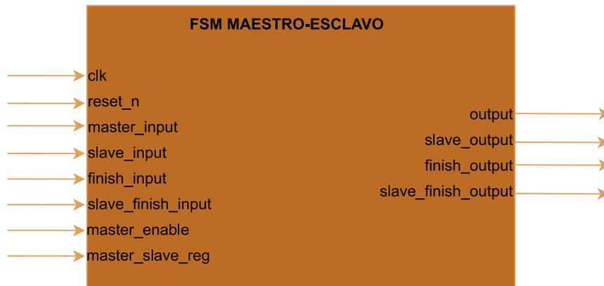
**Figura 39: Esquema de entradas y salidas de la fsm maestro/esclavo**
