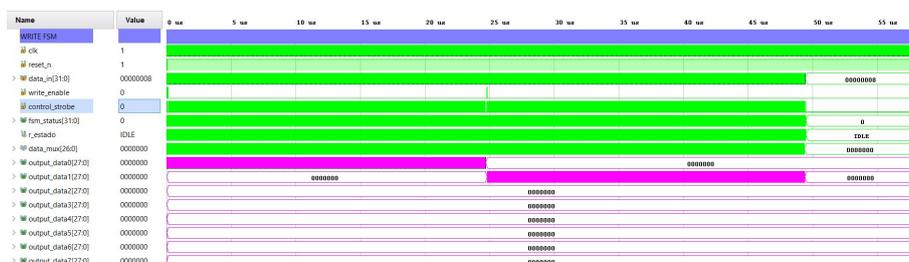
Figura 55: Simulación de la máquina de estados de escritura
