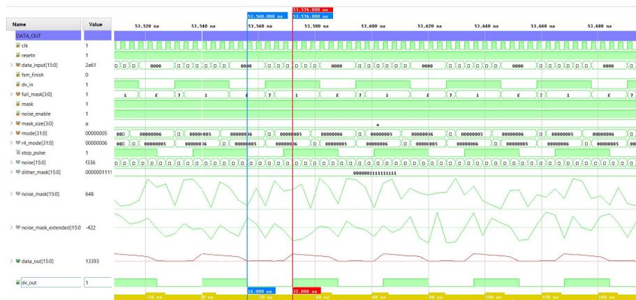
Figura 72: Simulación del módulo de salida en modo pulsos
