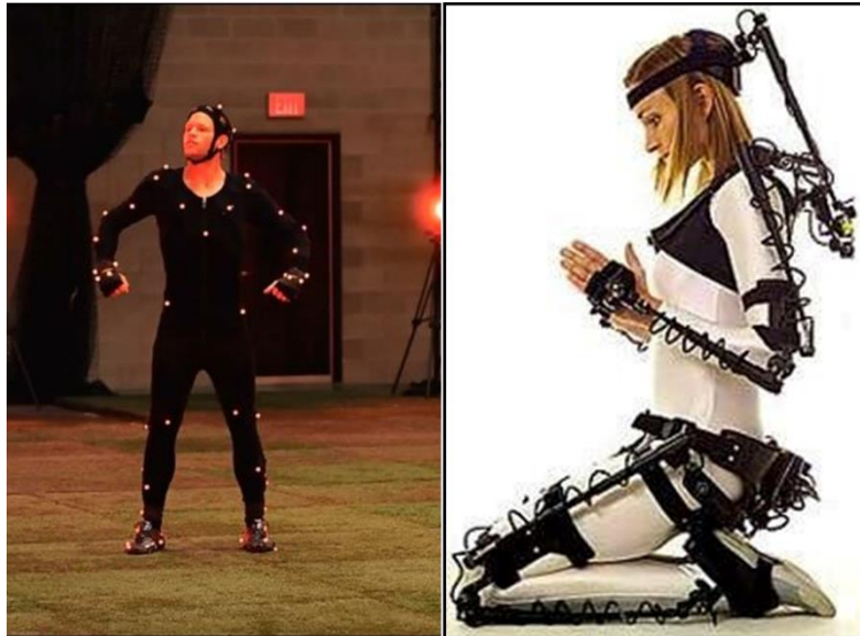
Ilustración 6. A la izquierda un sistema de captura óptico, a la derecha uno mecánico (no óptico).
