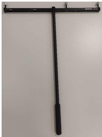
Ilustración 28. Vara de calibración modelo CW-500
