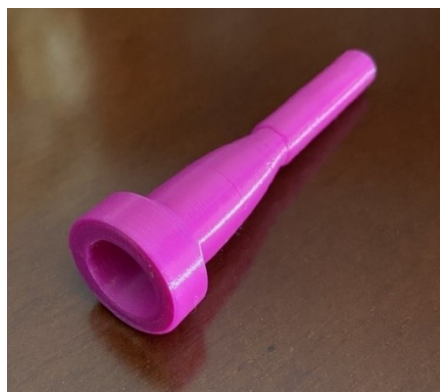
Figura 6.4: Diseño de boquilla de trompeta 2 impresa en impresora 3D
