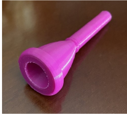
Figura 6.5: Diseño de boquilla de trompeta 3 impresa en impresora 3D
