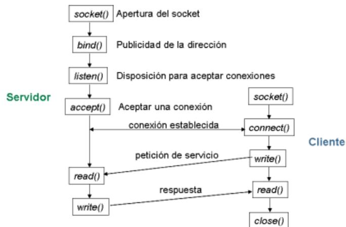
Figura 13. Secuencia de llamadas para una comunicación orientada a conexión
