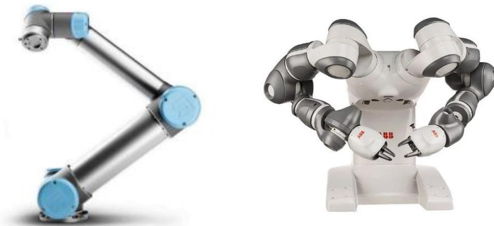
*Figura 12. Robot colaborativo UR5 (izq) y robot articulado YuMi IRB 14000 (dcha)*
