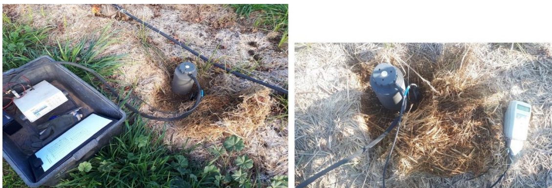
Figura 4. Detalle de la medida de la respiración del suelo in situ y la medida de la temperatura y humedad del suelo.
