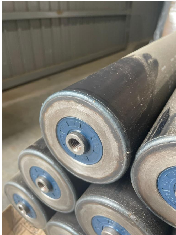
Figura 25: Detalle rodillo de gravedad con tapa soldada.
