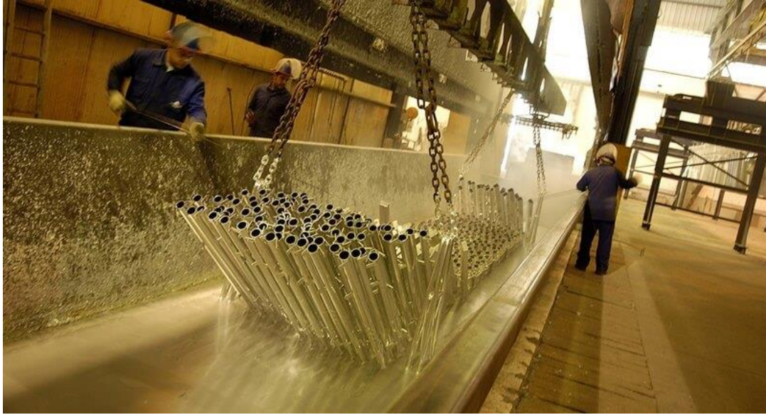
Figura 6: Proceso de galvanizado en caliente.
