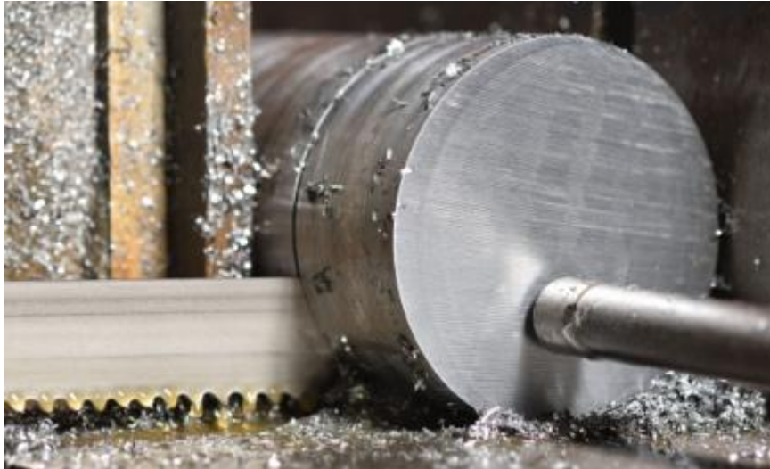
Figura 49: Proceso de corte de metal con sierra eléctrica.
