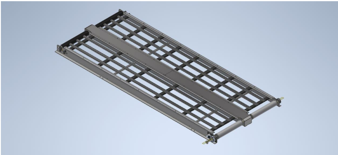
Figura 5: Vista 3D del bastidor del transportador.
