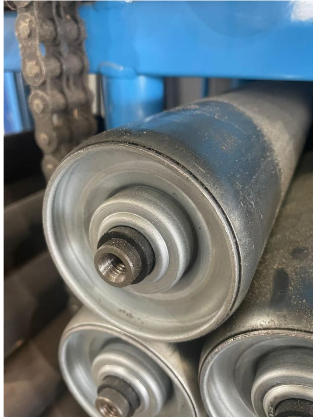
Figura 26: Detalle rodillo de gravedad con tapa embutida.
