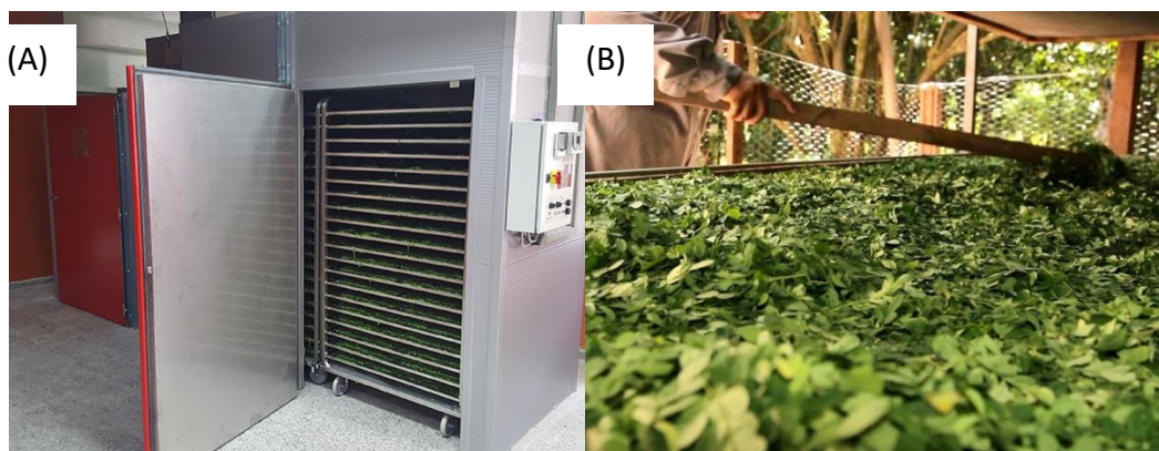
Figura 2. Tipos de equipos de secado de moringa; (A) Secador de bandejas, (B) Secador artesanal de aire (CONA, 2022; Yguá, 2022)
