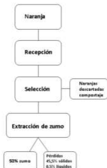
Figura 2. Diagrama de flujo de la producción de zumo de naranja (Rezzadori et al. , 2012).
