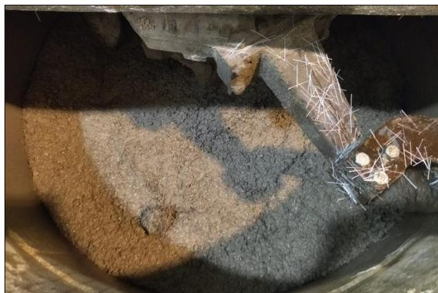
**Figura 3.5.** Formación de “pelotas de fibras” durante el amasado de la Prueba 3
