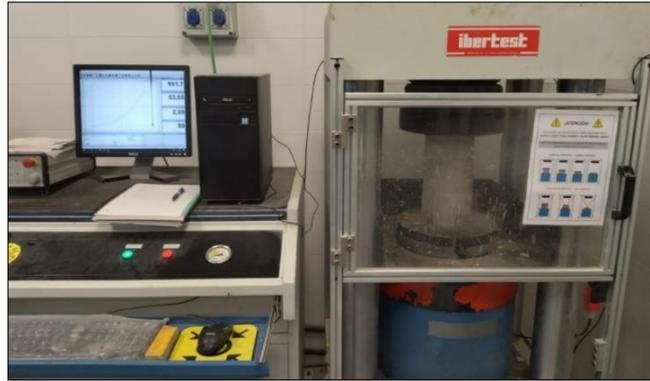
Figura 3.7. Máquina de ensayo universal Ibertest MEH – 3000 LC
