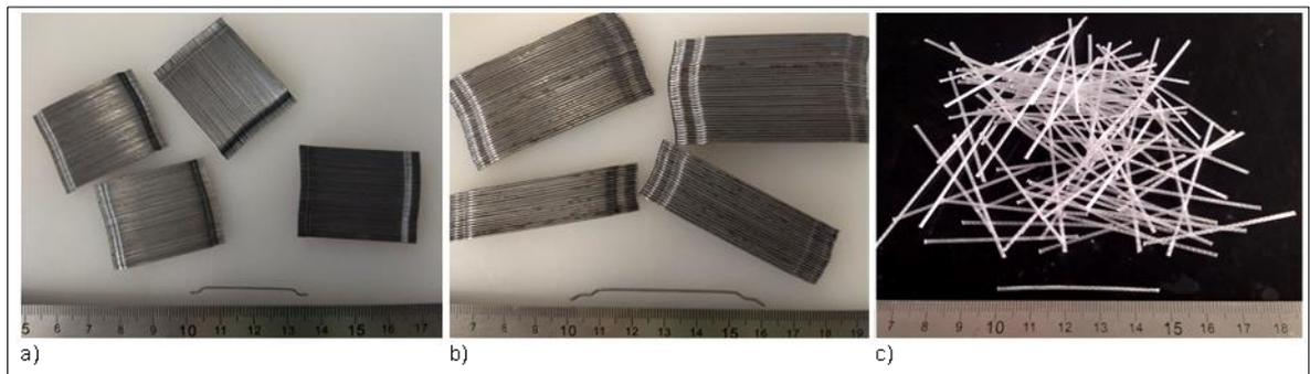
**Figura 3.2.** Fibras empleadas. a) Dramix 3D 65/35 BG; b) Dramix 4D 65/60 BG y c) BarChip 48
