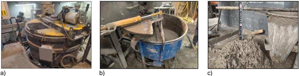
**Figura 3.4.** a) Amasadora; b) Vertido en tolva de distribución; c) Medida de la consistencia del hormigón
