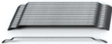
Dramix® 4D 65/60BG es una fibra trefilada al frío, de acero brillante, con anclajes en los extremos para un óptimo y eficiente en costo, refuerzo del concreto, mortero o lechada. Está encolada en fajos para fácil dosificación.
