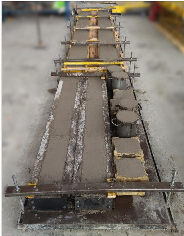
Figura 3.6. Lote de especímenes y probetas de caracterización hormigonados
