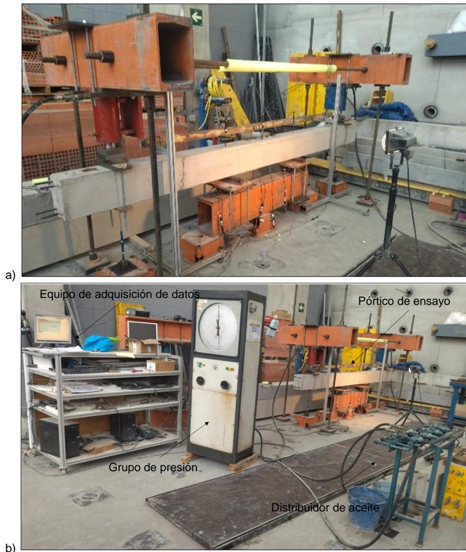
**Figura 3.11.** a) Vista general de la configuración del ensayo; b) Vista general de la disposición del ensayo
