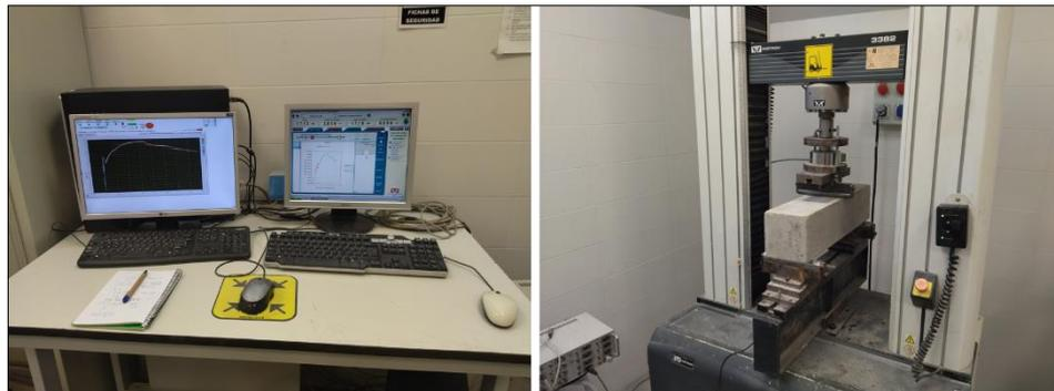
Figura 3.8. Máquina de ensayo universal Instron 3382
