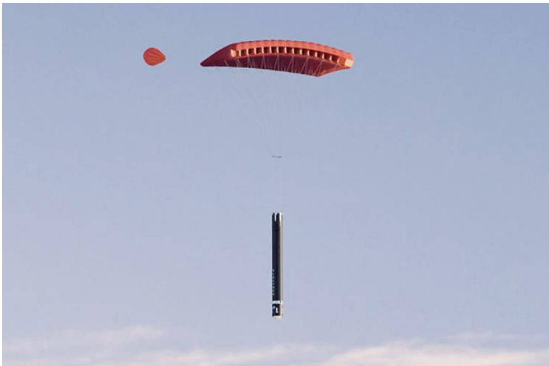
Figura 8: Cohete en fase de recuperación con paracaídas desplegados (NTRGUADALAJARA, 2020)
