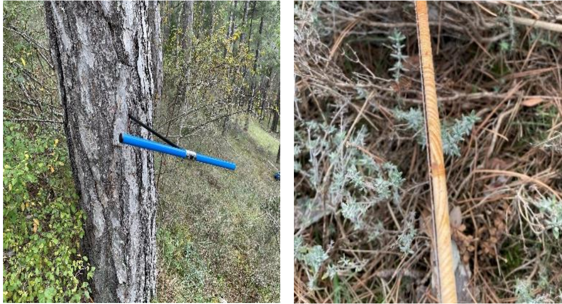
Figura 6. Izquierda. Barrena Pressler. Derecha: Detalle de la muestra extraída. Elaboración propia
