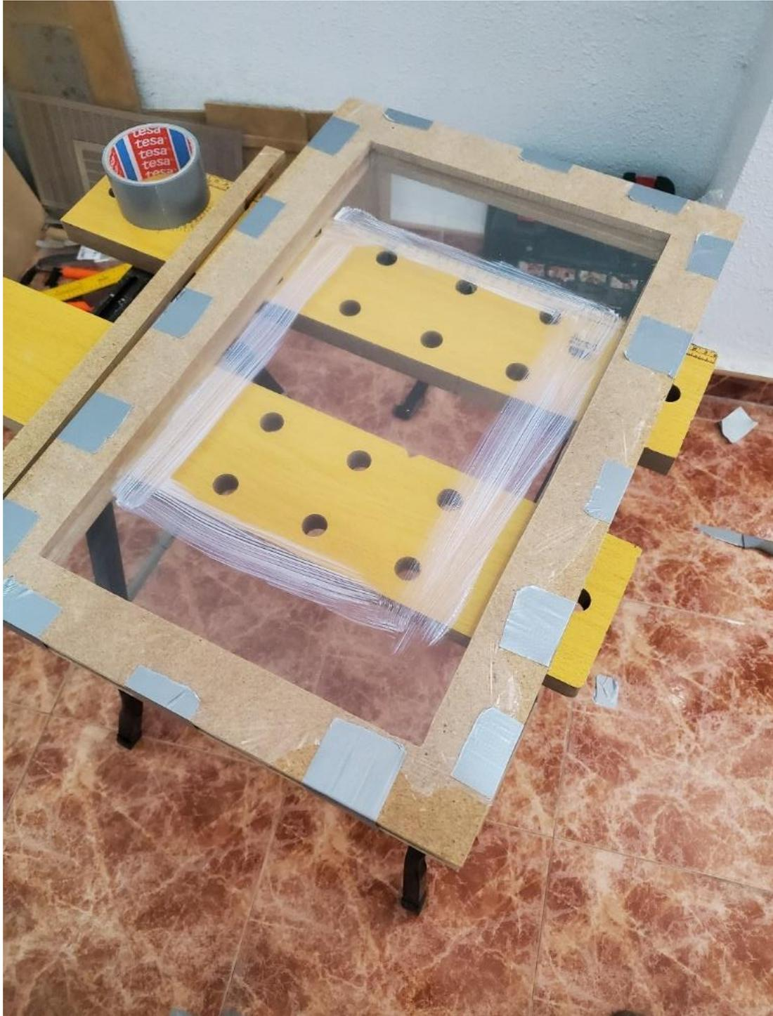
Ilustración 15 Membrana de mylar tensado y preparado con cola de contacto.
