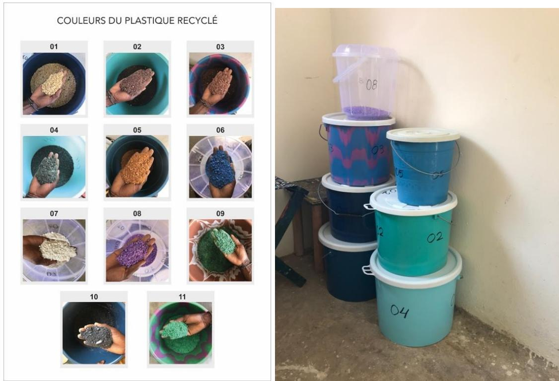
IMAGEN 174. CODIFICACIÓN DE PLÁSTICO TRITURADO PARA SEPARACIÓN EN CUBOS.
