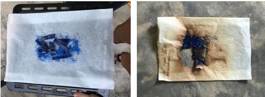
IMAGEN 79. PRIMER FUNDIDO EN EL HORNO DE PLÁSTICO TIPO PP. FUENTE: PROPIA
