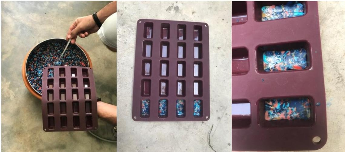
IMAGEN 137. FUNDIDO DE PLÁSTICO TRITURADO EN MOLDE DE SILICONA. FUENTE: PROPIA
