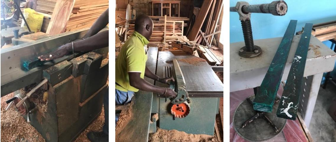
IMAGEN 107. PROCESO DE REBOTADO DE LISTONES. FUENTE: PROPIO
