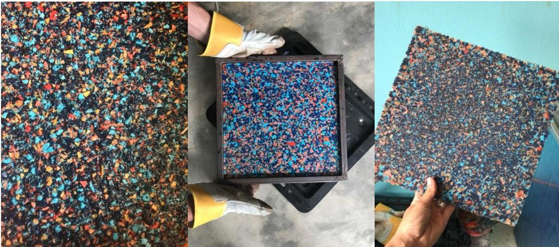
IMAGEN 96. PRUEBA DE PRIMERA PLANCHA CON PP. FUENTE: PROPIA
