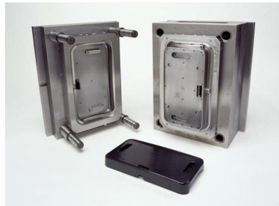
IMAGEN 53. MOLDES PARA INYECCIÓN DE PLÁSTICO. FUENTE: [WWW.INDUSTRIASLESIL.COM](http://WWW.INDUSTRIASLESIL.COM)
