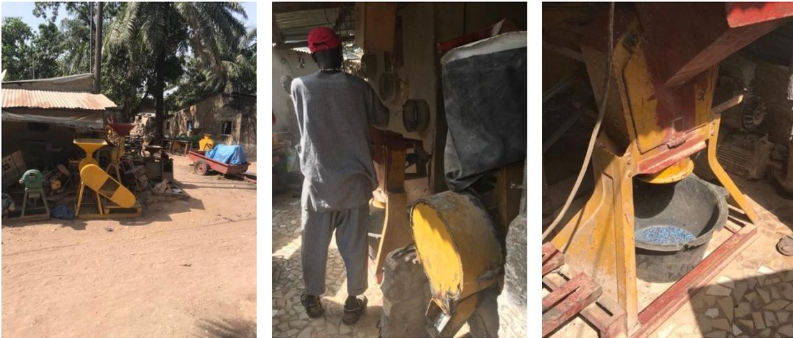
IMAGEN 130. PRIMER TRITURADO DE PLÁSTICO A MÁQUINA. FUENTE: PROPIA
