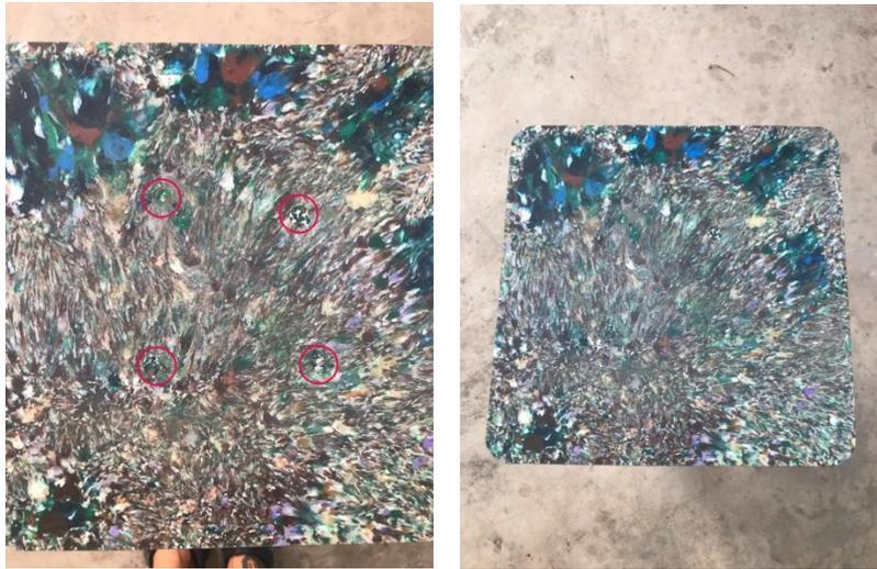
IMAGEN 228. TORNILLOS TAPADOS CON PLÁSTICO FUNDIDO AÑADIDO. FUENTE: PROPIA
