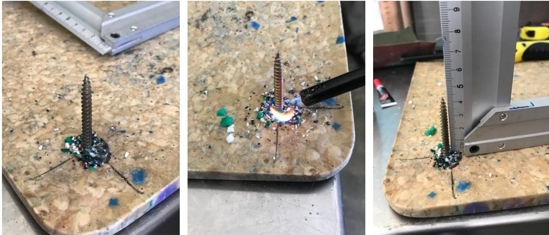
IMAGEN 226. UNIÓN DE TORNILLOS A PLANCHA MEDIANTE FUNDIDO. FUENTE: PROPIA
