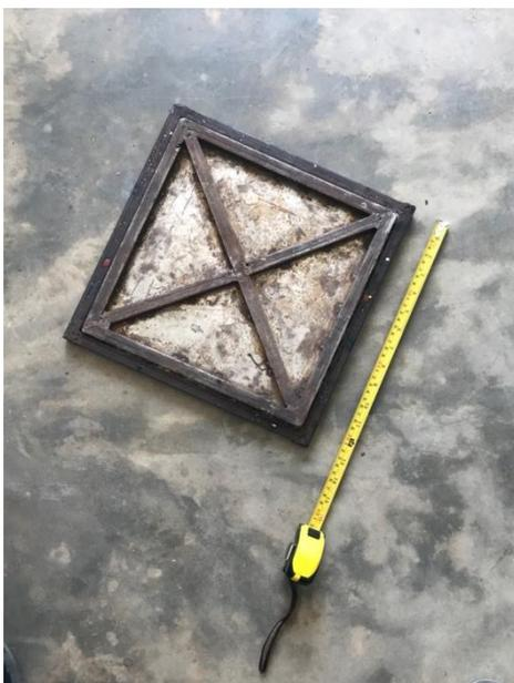
IMAGEN 95. MOLDE DE ACERO PARA REALIZACIÓN DE PLANCHAS. FUENTE: PROPIA
