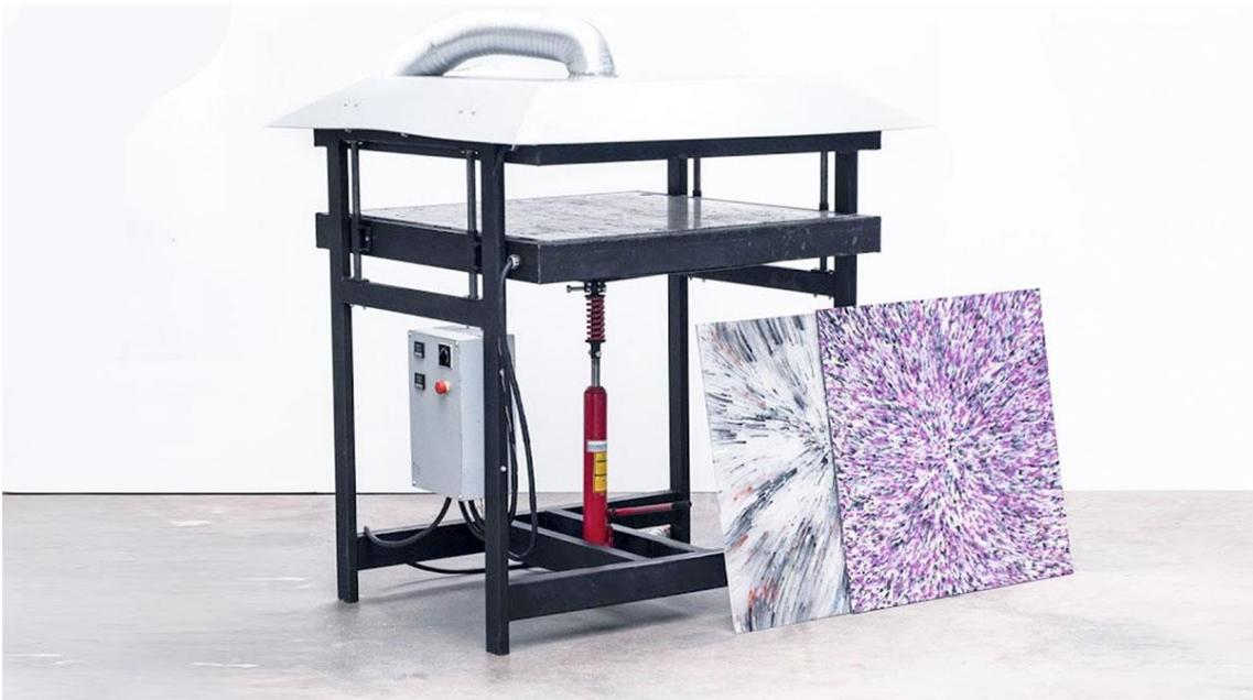
IMAGEN 54. PLANCHA DE PENSADO DE PLÁSTICO. FUENTE: WWW.PRECIOUSPLASTIC.COM
