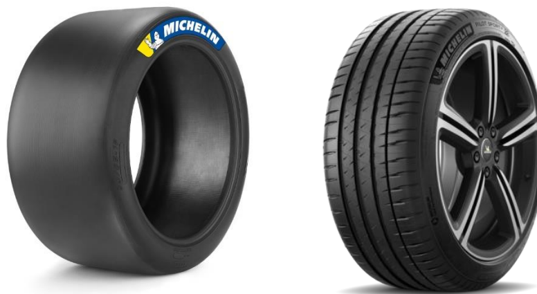
Figura 3.9. A la izquierda un neumático de competición “Slick” y a la derecha un neumático de serie. Fuente: michelinmotorsport.com
