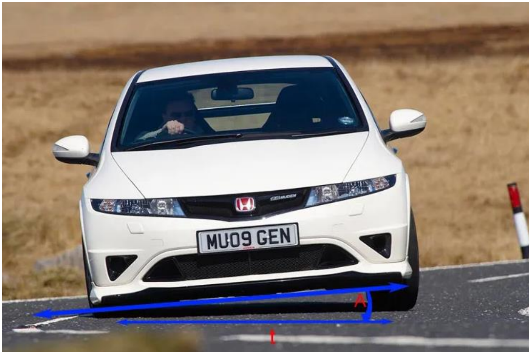
Figura 1.2. Descripción gráfica de un vehículo tomando una curva en la cual se puede ver como gira el coche sobre su eje longitudinal.
