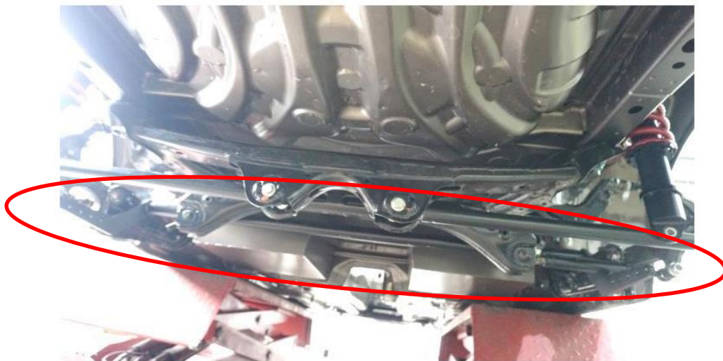
Figura 1.1. Imagen detalle de la colocación de la barra de torsión delantera. Fuente: Imagen propia.
