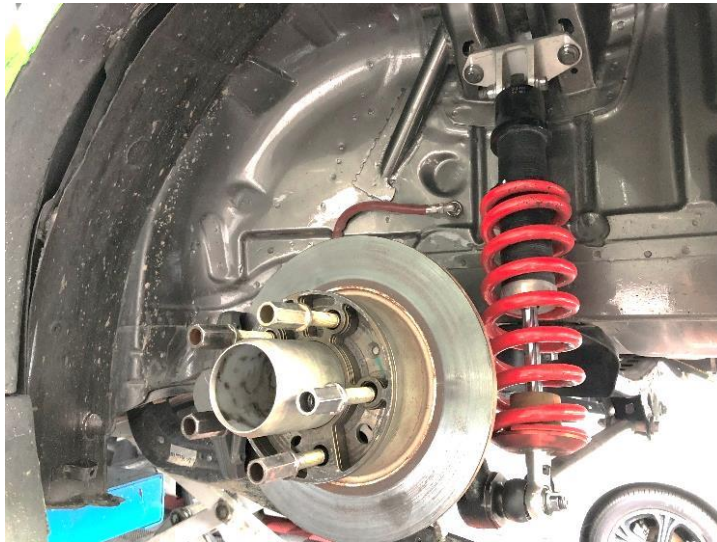
Figura 3.10. Suspensión trasera del MG6 X-POWER con muelles y amortiguador. Fuente: Imagen propia
