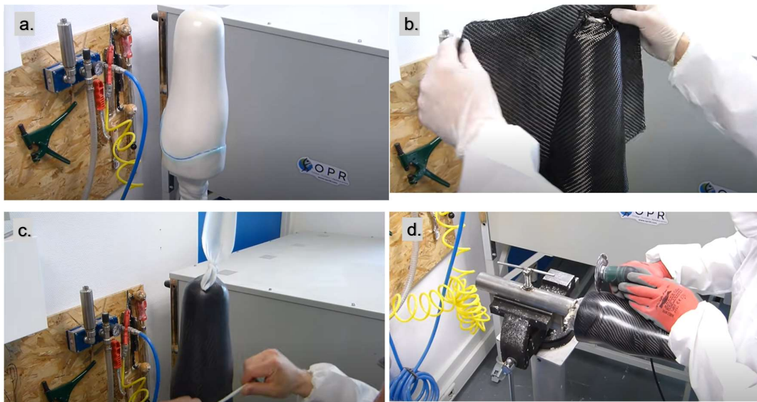
Ilustración 44. Proceso de laminación de fibra de carbono. En orden: negativo preparado para la laminación (a), laminación con la fibra de carbono intercalada con epoxi (b), eliminación de imperfecciones a través del vaciado (c), eliminación de rebabas y defectos (d).
