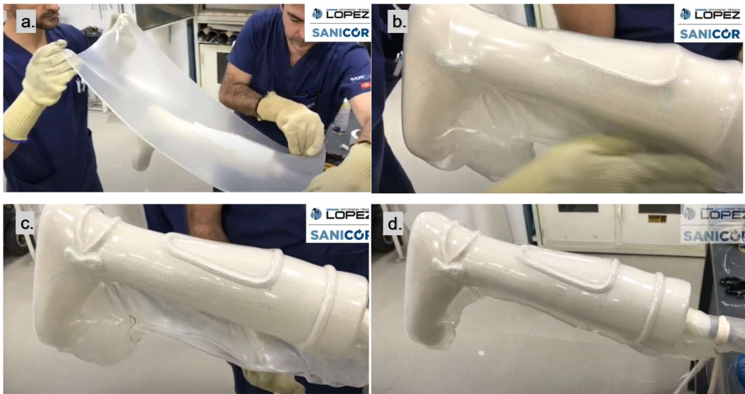
Ilustración 43. Proceso del termoconformado por vacío. En orden: colocación de la lámina (a), adaptación de la lámina (b), final del proceso de vaciado (c), recorte del sobrante (d).
