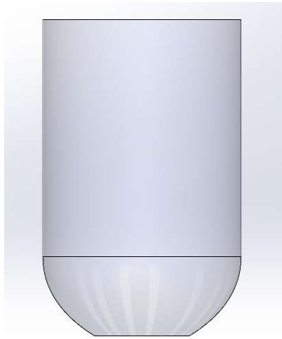
Ilustración 19. Resultado de extruir mediante revolución el croquis de la Ilustración 18
