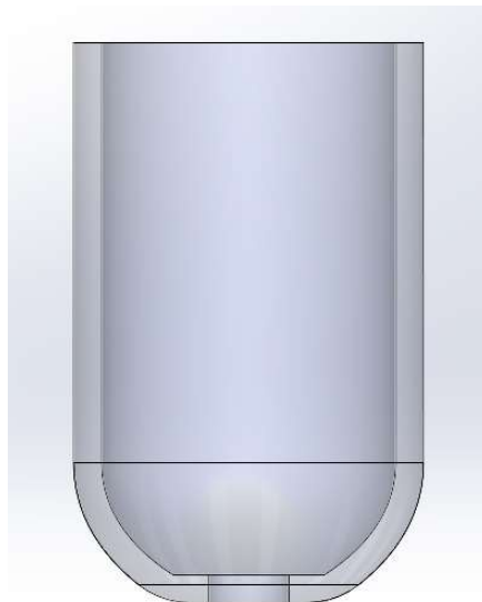
Ilustración 20. Resultado del vaciado de la pieza obtenida.
