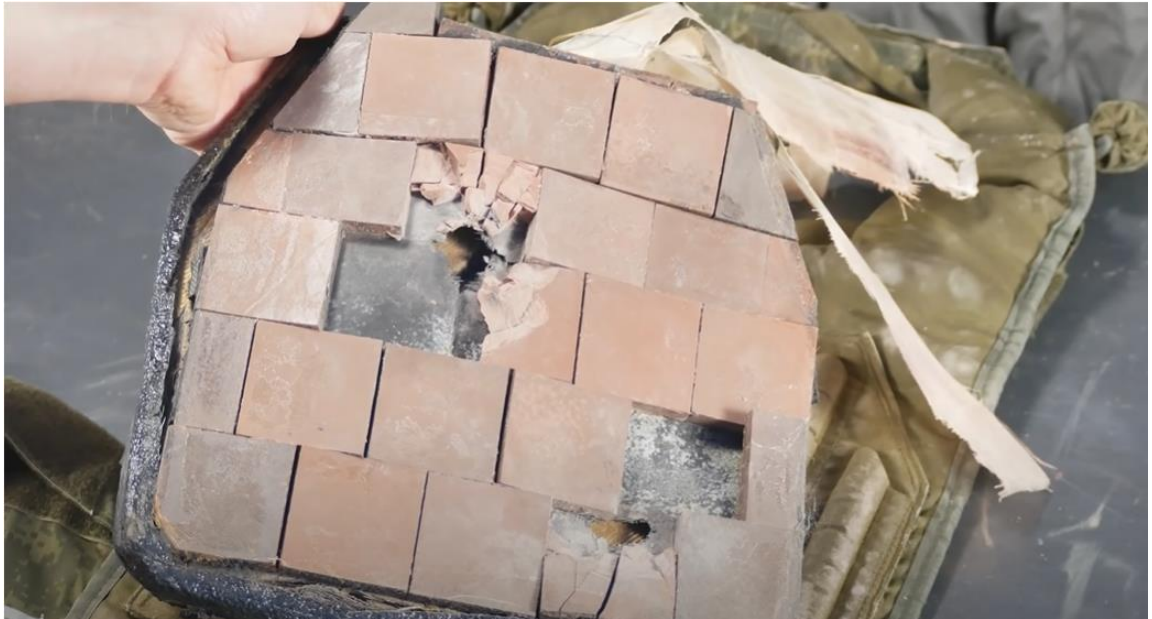
Ilustración 16. Interior de una placa cerámica 6B45 "Granit" Gost 5A/6A.[11]
