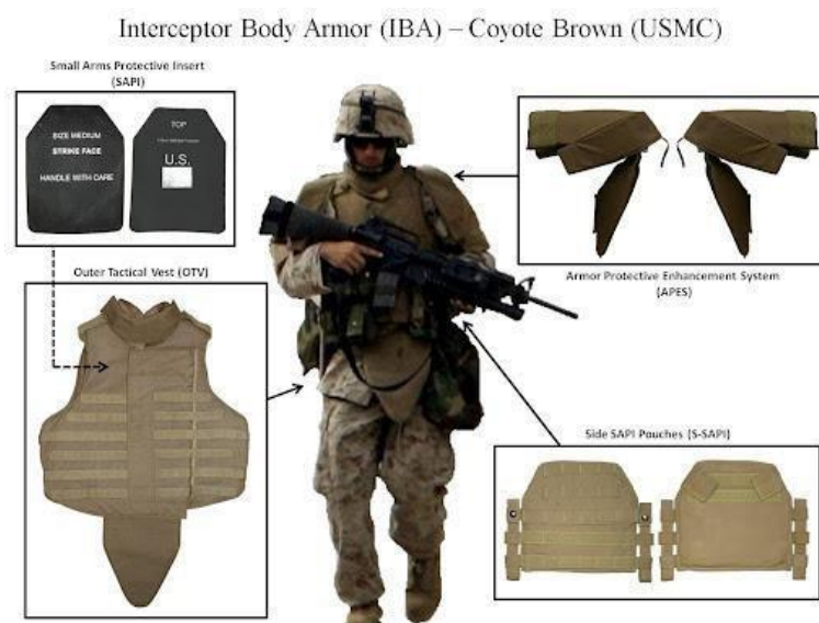
Ilustración 20. Esquema del equipamiento IBA desglosado, siendo usado por un soldado.
