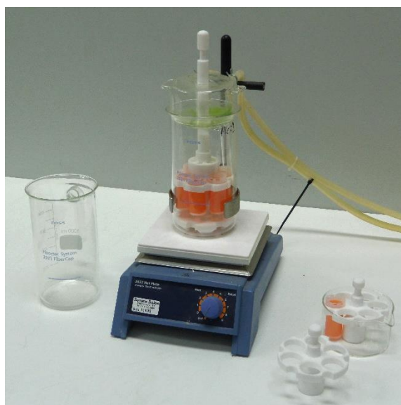
Figura 12. Sistema de extracción de fibra FT 221 FiberCap™ incluyendo la placa calefactora Foss Tecator 2022 Hot Plate, las jarras de extracción, el carrusel y las cápsulas FiberCap™. Fuente: Severn Sales.
