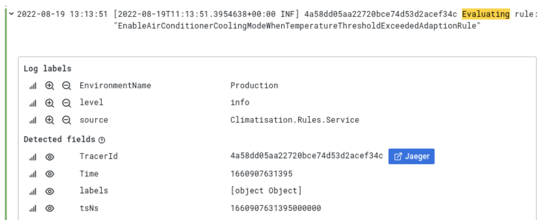
Figura 7.3: Ejemplo de la estructura de un registro.
