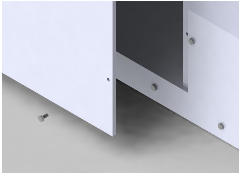
Ilustración 91. Ensamblaje subconjunto 1. Zoom Unión roscada 1.8 – 1.6, 1.6 x 2.
