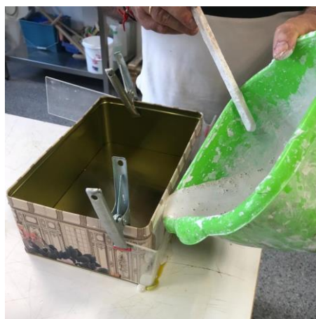
Ilustración 156. Vertir la escayola al molde.
