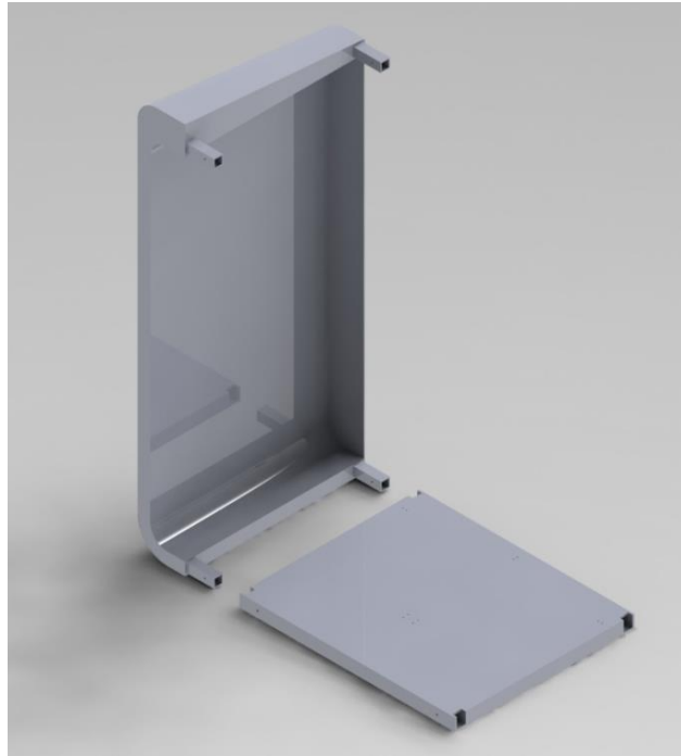
Il·lustració 76. Ensamblaje subconjunto 1. Unión 1.1 - 1.3.
