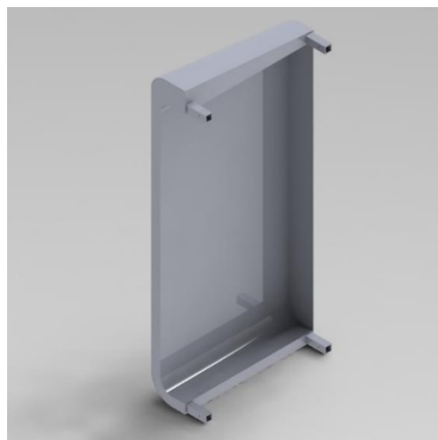
Ilustración 50. Ensamblaje subconjunto 1.1. Soldadura 16, 17 y 18.
