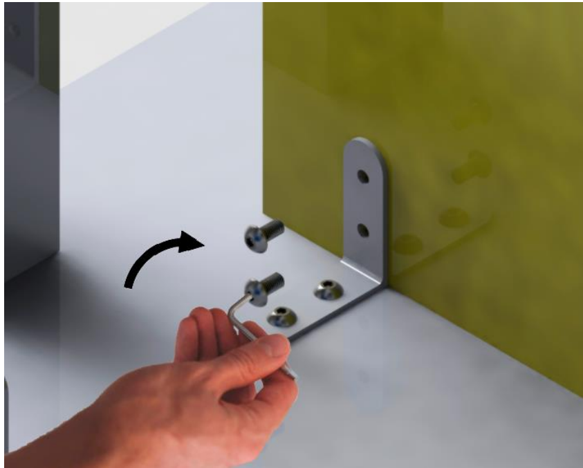
Ilustración 106. Ensamblaje conjunto. Unión roscada 8 - 7, 3.
