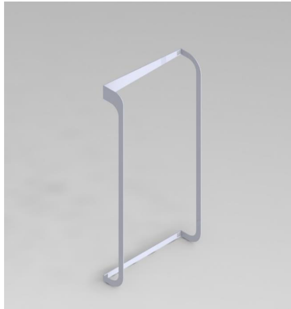
Ilustración 53. Ensamblaje subconjunto 1.2. Soldadura 3 y 4.
