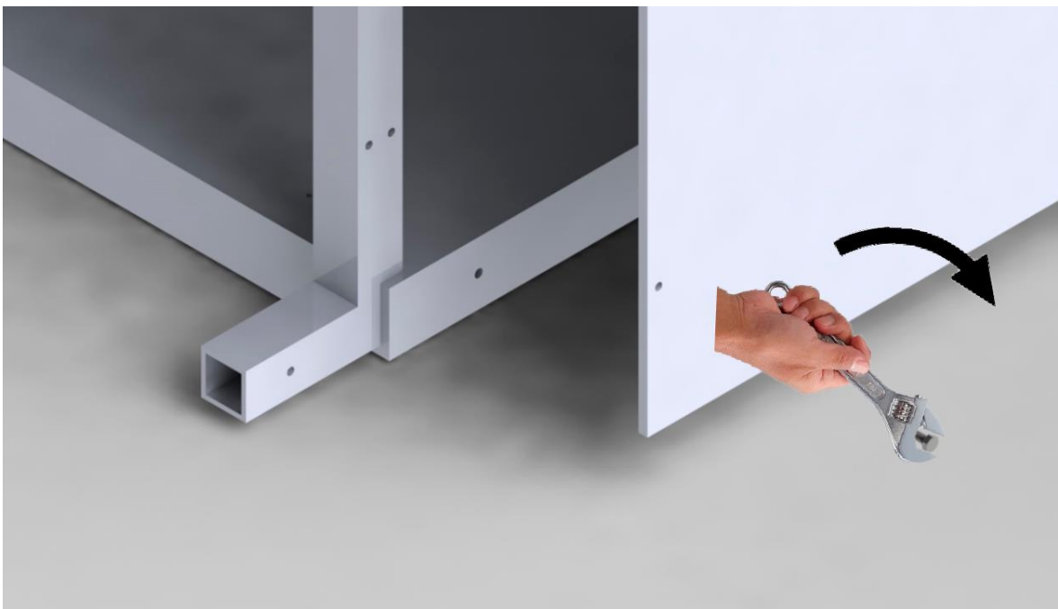
Ilustración 87. Ensamblaje subconjunto 1. Proceso de giro con llave M8x16.
