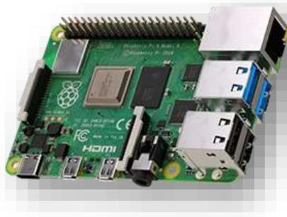
Fig. 6. Raspberry Pi 4 Model B
