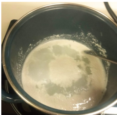
Figura 12 Eliminación del agua excedente por evaporación
